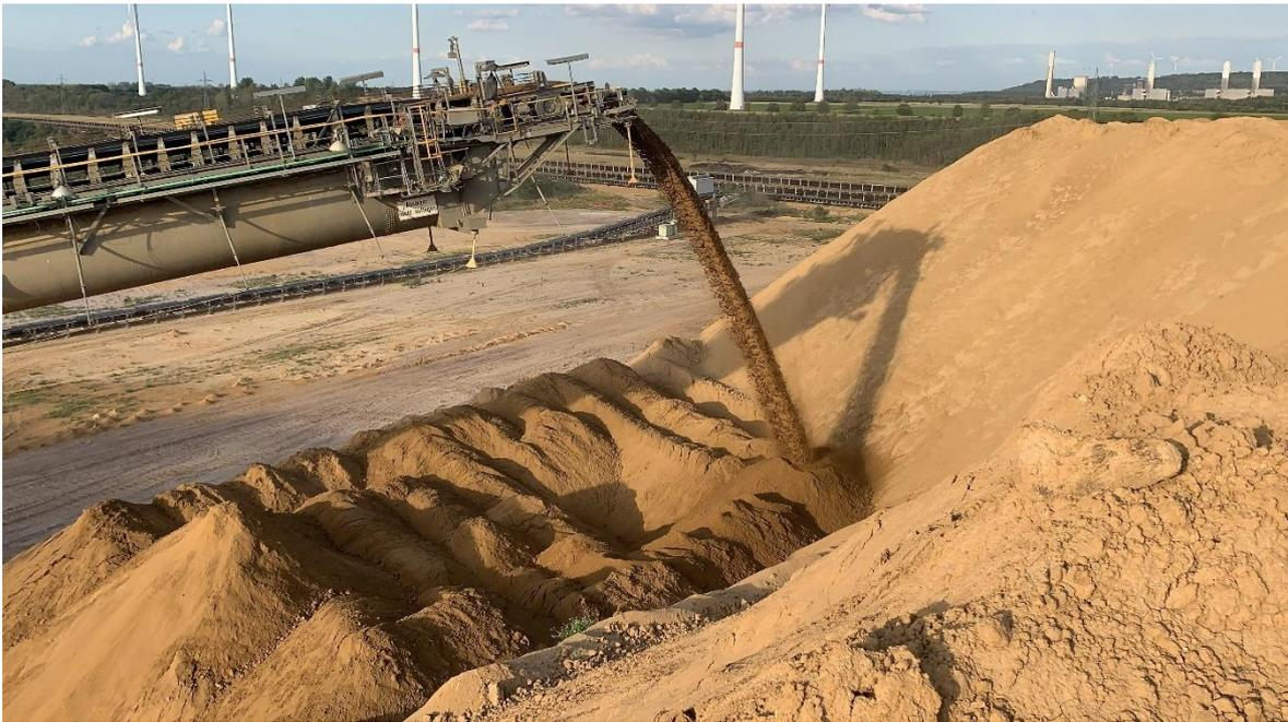
**Bild 8:** Automatischer Wechsel aus dem Vorplanum ins Planum
