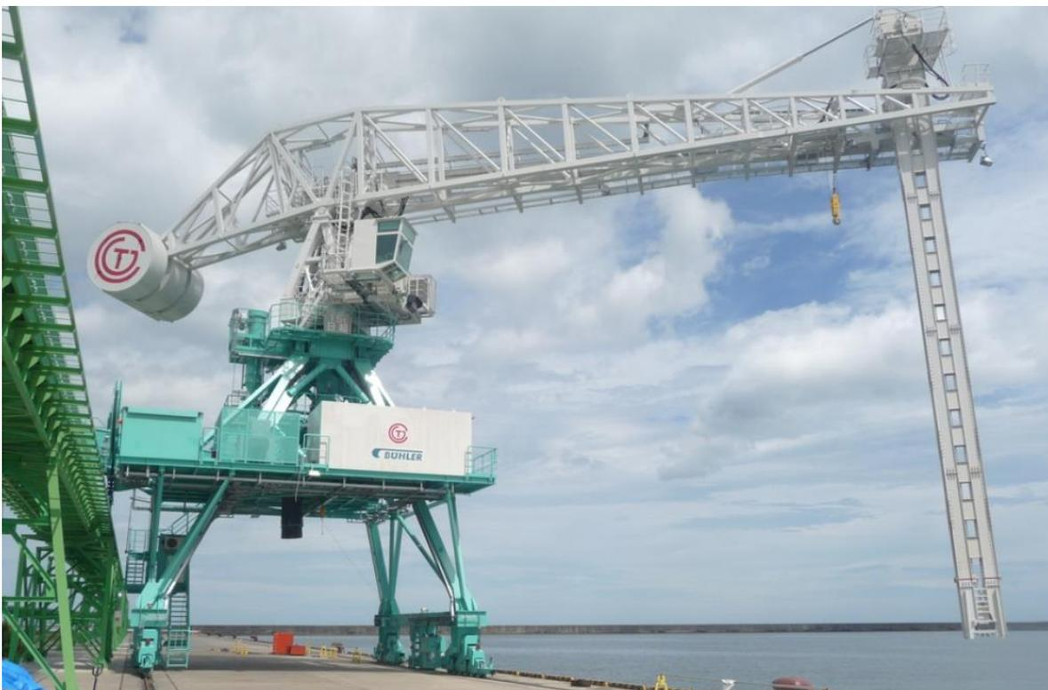
**Bild 1:** Typischer Aufbau eines Schiffsentladers [Bühler AG Uzwil]
