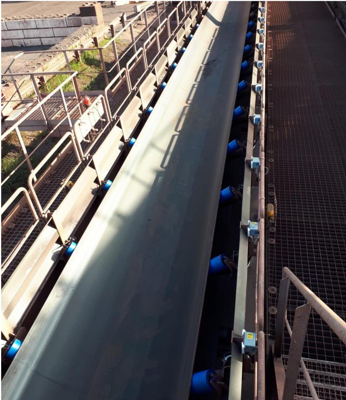
**Bild 6:** Zehn mit Sensing Idler ausgerüstete Stationen
