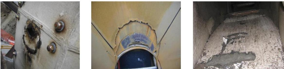
**Bild 1:** Typische Beispiele für Verschleiß in der Fördertechnik aus der industriellen Praxis [1]
