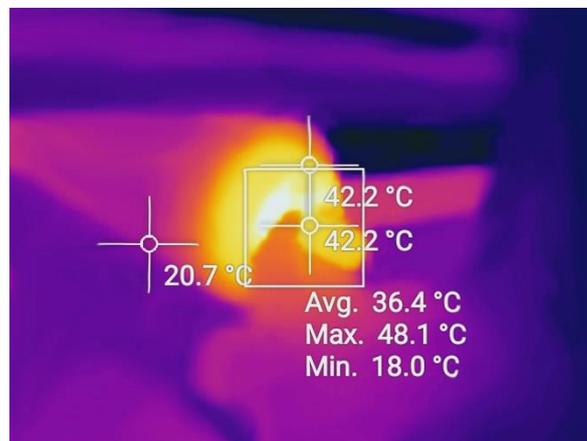
**Bild 2:** Thermoaufnahme einer Tragrolle
