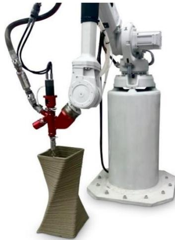
**Bild 4:** Darstellung eines klassischen Pumpbeton Material Extrusionsprozesses [8]
