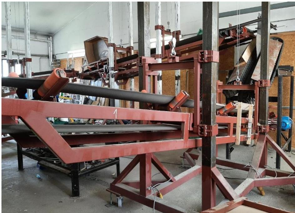
**Bild 2:** Institutseigener Förderkreislauf mit „FlowScrape“ am Prüfstand
