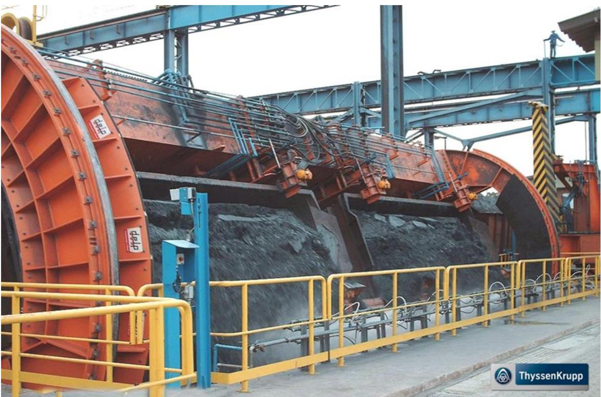
**Bild 18:** Rundkipper beim Entleeren der Waggon
