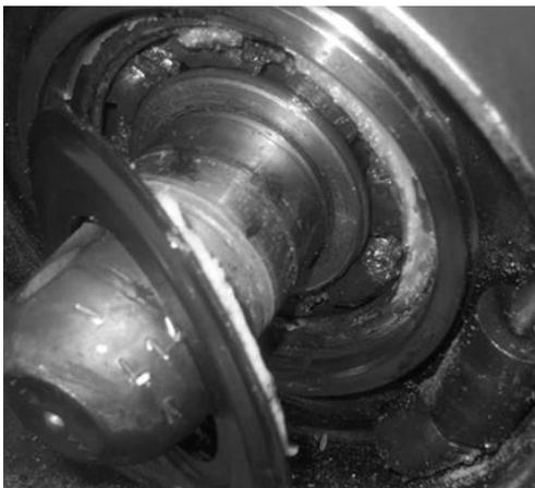
**Bild 1:** Verschmutztes und durch Korrosion geschädigtes Wälzlager durch Abdichtungsversagen
