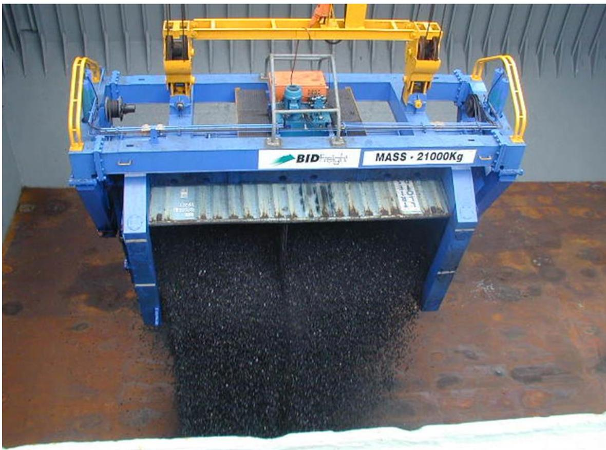
**Bild 24:** Container-Kippvorrichtung beim Leeren eines Containers
