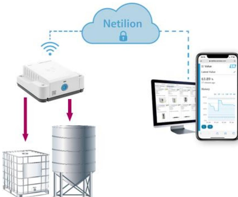
**Bild 1:** Systemaufbau Cloudbasierte Füllstandsmessung
