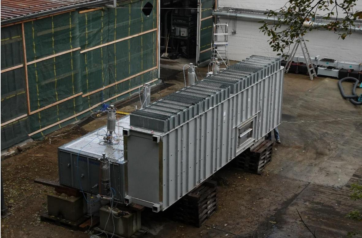
**Bild 5:** Prüfmuster im Maßstab 1:1 inkl. Mittelteil und Flammenabsorber
