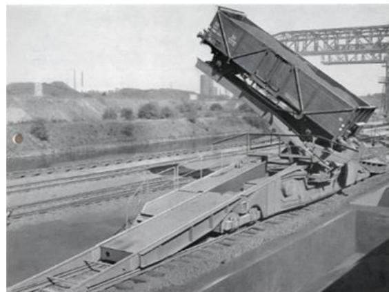
**Bild 2:** Fahr- und drehbarer Waggonkipper [Pohlig]
