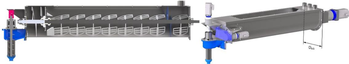
**Bild 5:** Links: Querschnitt des Mischsystems ohne Antriebselemente mit dem Zulaufbereich rechter Rand, Nassmisch- und Förderbereich Mitte und Kompressionsbereich links vertikal angeordnet; Rechts: Gesamtansicht des Mischsystems „near-nozzle-mixing“ aus DFG-SFB TRR277
