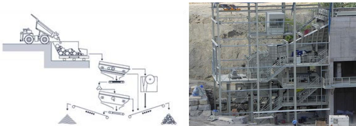
**Bild 2:** HAVER Vorbrechanlage Master-Variante
