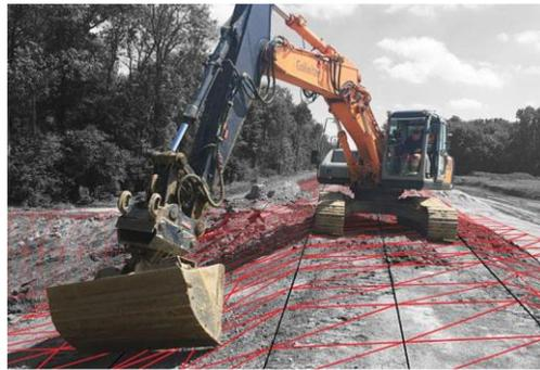
**Bild 1:** Geländenetz beim 3D Geländebaggern [1]
