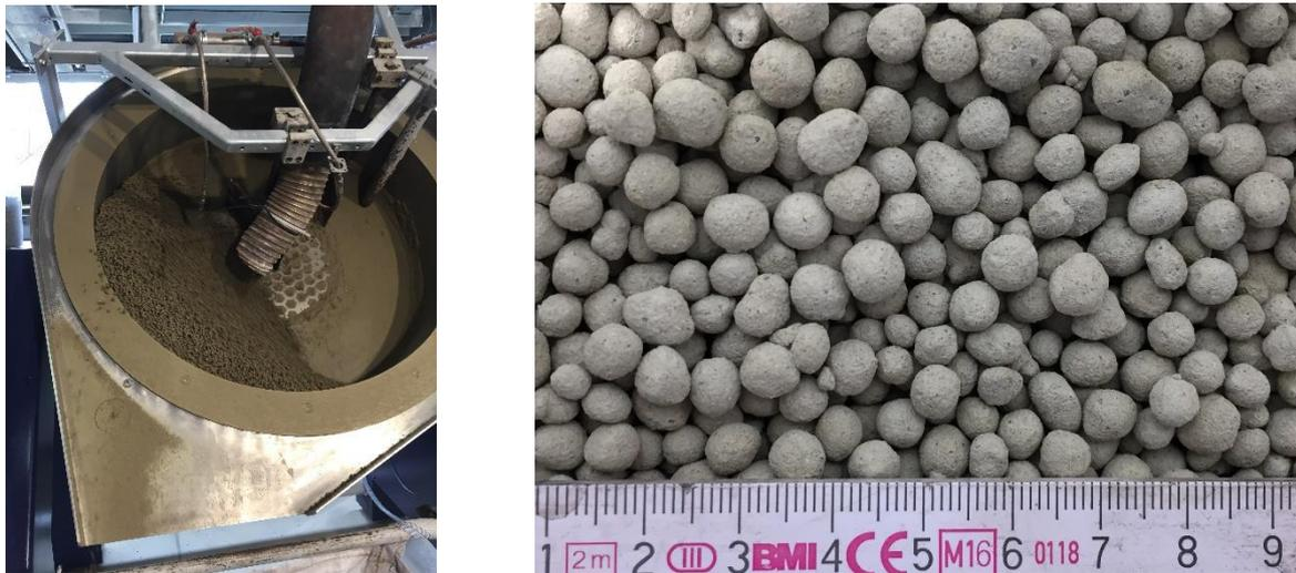
**Bild 4:** Füllmaterial im Pelletierteller bei Auslegungsversuch und Produkt
