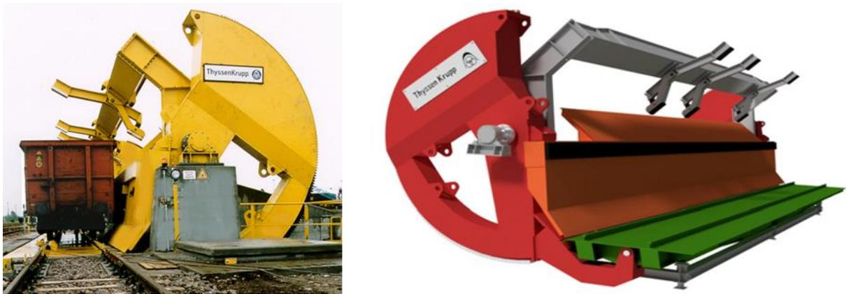
**Bild 13:** Seitenhochkipper Bauart thyssenkrupp
