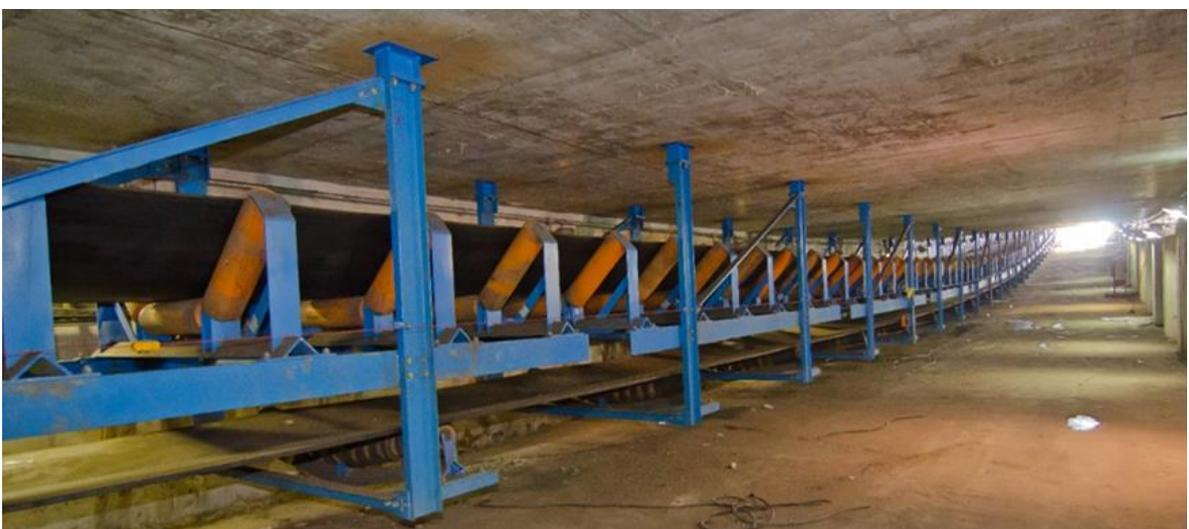
**Bild 10:** Gurtförderer zum Lagerplatz oder Schiffsbelader
