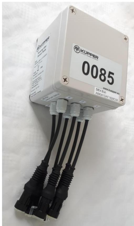
**Bild 5:** Sensing Idler Sensorknoten
