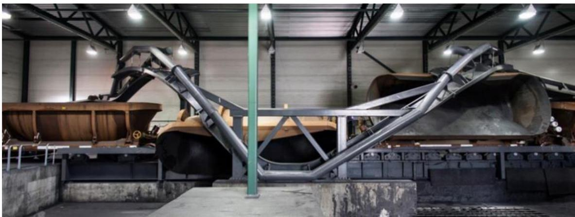
**Bild 26:** Spiralförmige Kulissenführung [Kiruna Wagon, Schweden]
