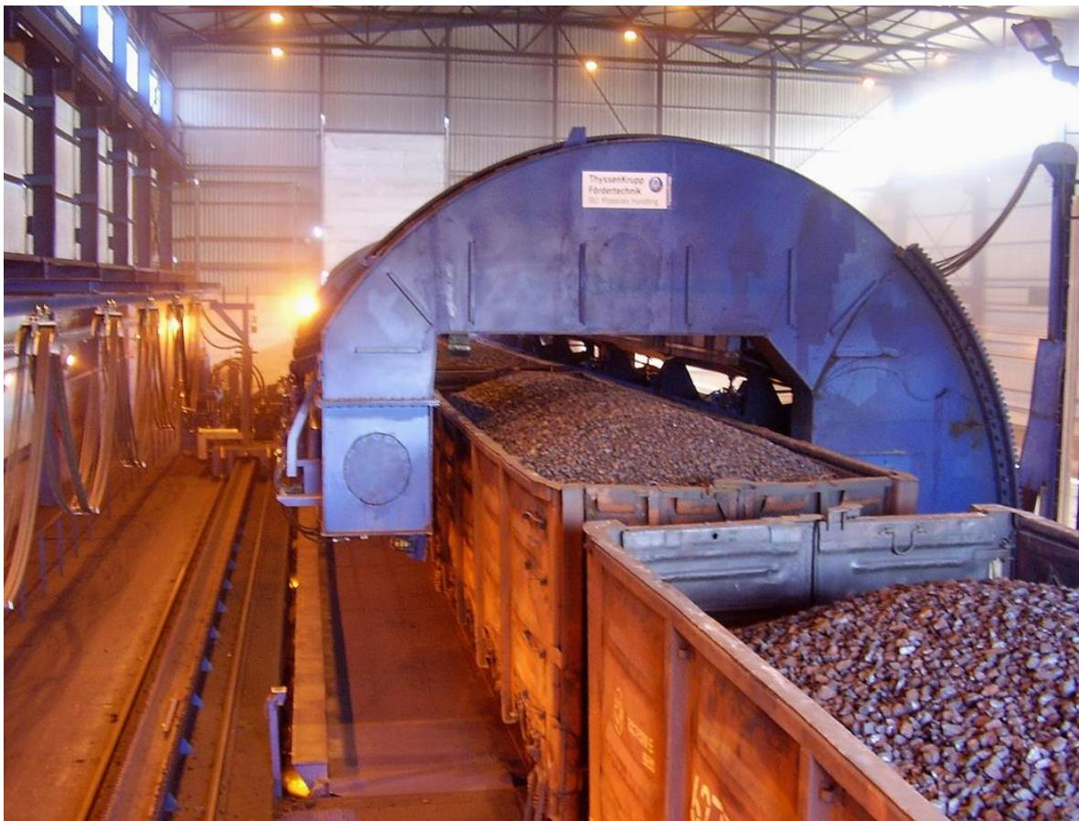
**Bild 16:** Rundkipper C-Form mit Waggon
