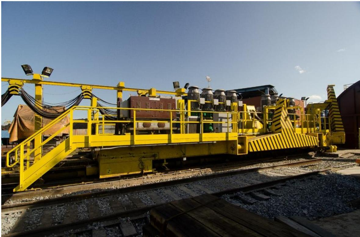
**Bild 21:** Zustelleinheit (Positioner, Indexer, Vorzieher oder Seitenarmvorzieher)
