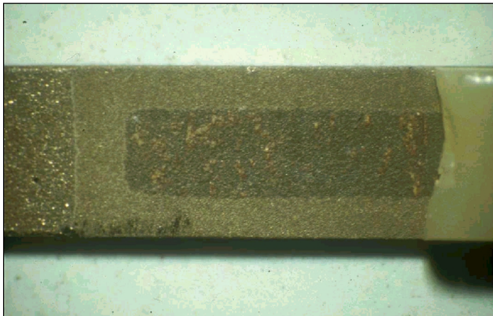
Abb. 21: Probekörper der Legierung Bio Herador N mit Korrosion, "gelasert und beschliffen", nach der Biege-Scherprüfung und nach manuellem Ablösen der durch die Prüfung vom Metall gelösten Keramikanteile. Die korrosionsbedingte Randzone ist deutlich zu erkennen.
