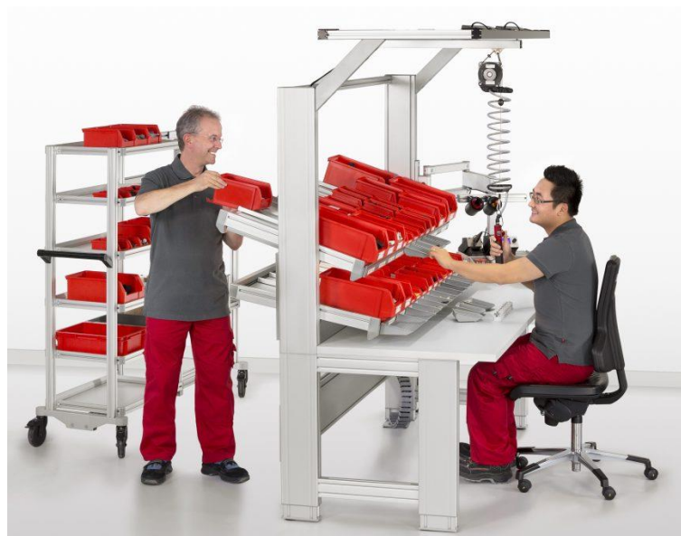
Abb. 36: Arbeitsszenario eines Montagetisches mit Rutsche bei 2. Variante (Quelle: item Industrietechnik, 2016)
