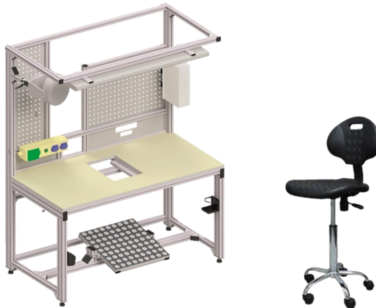
Abb. 38: Höhenkonstanter Montagetisch mit höhenverstellbarer Fußstütze und Stuhl (Quelle: ALUTEC KK, 2022 und D’Romerio, 2022)
