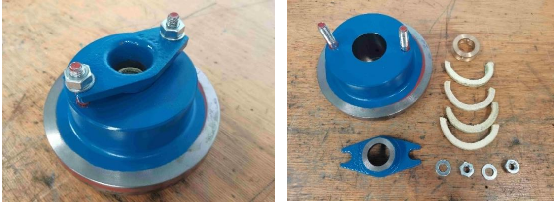
Abb. 17: Fotos und Teiledarstellung von Stopfbuchse (Quelle: eigene Abbildung)
