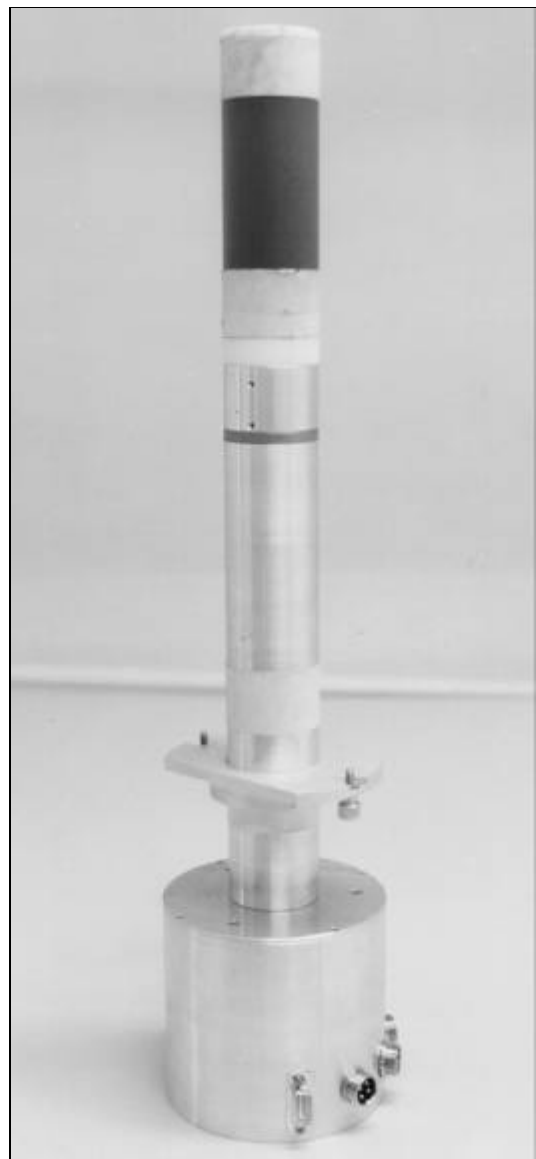
Abb. 4.2.3: Probenkopf mit integriertem Gradientensystem für einen narrowbore -Magnet
