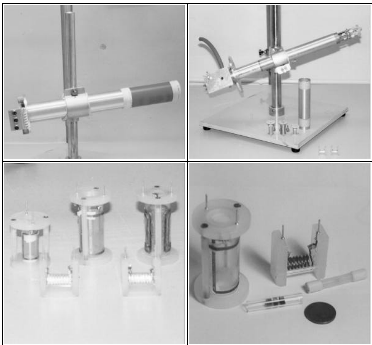
Abb. 4.2.2: Gradientensystem (aktiv geschirmt), Probenkopf und austauschbare Proben-Spulen des neuen Eigenbausystems für einen widebore -Magneten
