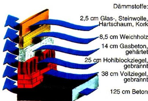
Verschiedene Dämmstoffe bei gleichem Wärmedurchgang
