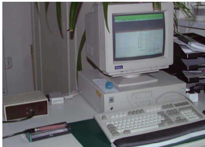
Abb.6: PC-Elektrogustometer : Elektrode, Reizmodul und PC
