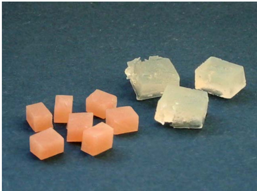
Abb. 8 Nach Lagerung in Chloroform angelöste und gequollene Probekörper (rechts) im Vergleich zum Ausgangsmaterial (links)
