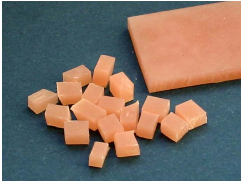
Abb. 5 Kunststoffgranulat nach der Zerkleinerung (Kantenlänge ca. 2 mm)
