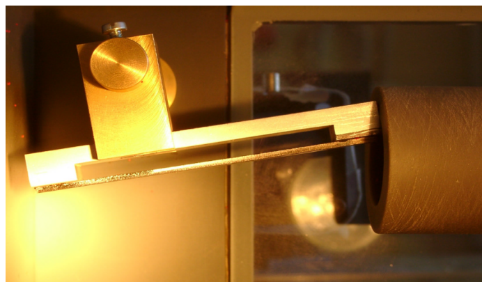
Abbildung 4-7: a), b) Versuchsstand mit Kamera für die Analyse der Wandkollision sphärischer und nichtsphärischer Partikeln.
