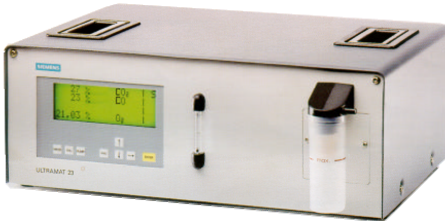
Abb. 5-05: Infrarot-Spektroskop SIEMENS Ultramat 23
