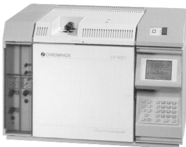
Abb. 5-03: Gaschromatograph CHROMPACK CP 900X
