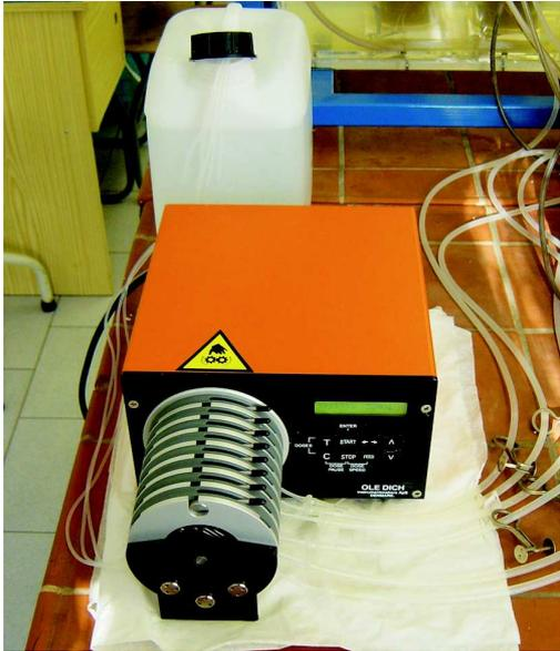
Abbildung 7: Dosierpumpe zur Förderung der Pufferlösung, 6 der 8 Ausgänge genutzt
