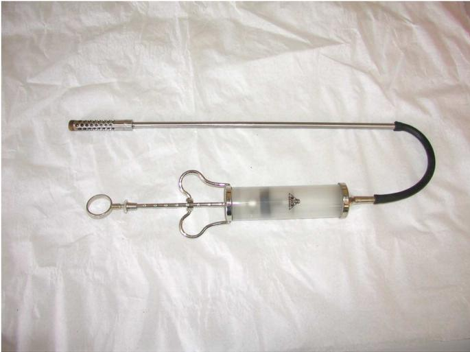
**Abbildung 9:** Saugrohr mit aufgesetztem Filter und Spritze zur Entnahme der flüssigen Phase des Panseninhaltes
