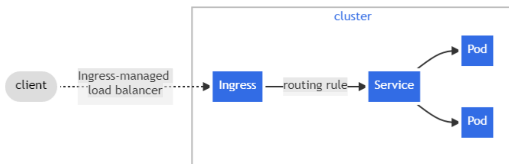
Abbildung 10: schematischer Aufbau der Routing-Architektur in Kubernetes [36]
