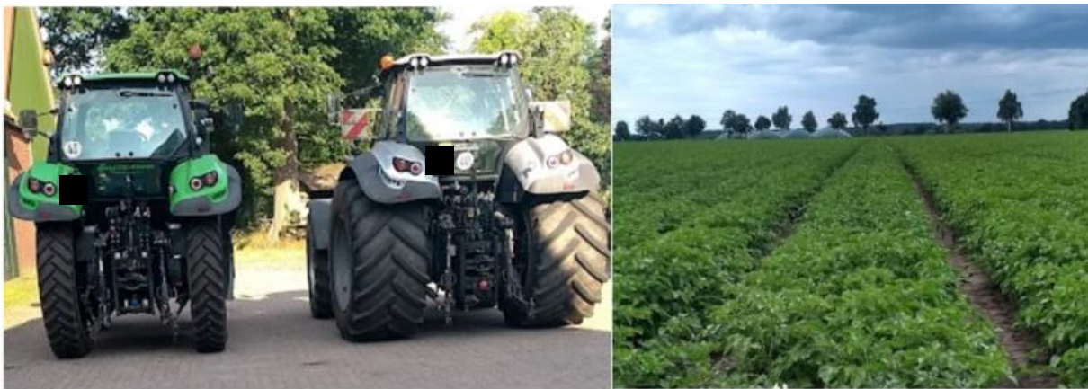
Abbildung 2: optischer Vergleich von Pflege- und Breitreifen (links) und Fahrgasse im Kartoffelfeld (rechts)
