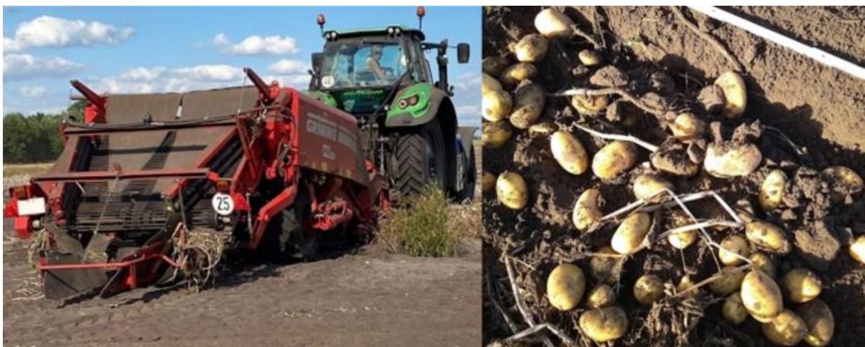
Abbildung 14: maschinelle Ernte und darauffolgend zu findende Kluten in der Erntemenge
