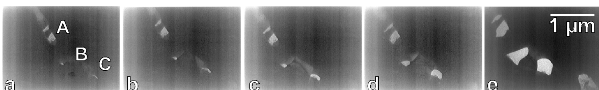
Abb. 5.43: Das Aufreißen der Korngrenzenphase illustrierende Sequenz von Video-Aufnahmen eines In-situ-Dehnversuches bei 1100°C.
