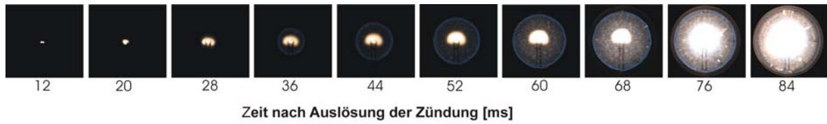
Abb. A5.1: Flammenausbreitung in einem Propan-Luft-Stickstoff-Gemisch bei geschlossener Versuchsanordnung mit 2 l Volumen, L/D von ca. 1 und zentraler Zündung mit glimmendem Draht
