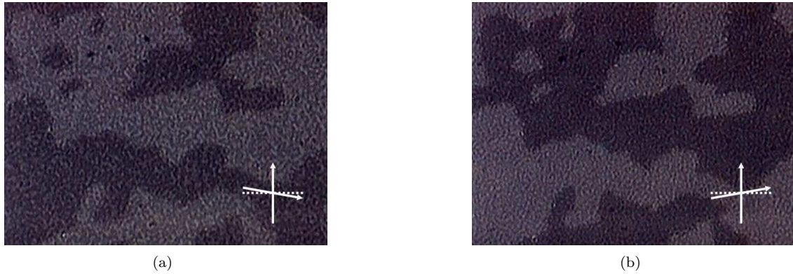
Abbildung 3.21. Texturen mit Domänen entgegengesetzter Händigkeit in der \text{SmCP}_A -Phase von Verbindung 5a ( T = 107 \text{ }^\circ\text{C} ). Ein Polarisator wurde um +10^\circ (a) und -10^\circ (b) aus der gekreuzten Stellung gedreht.
