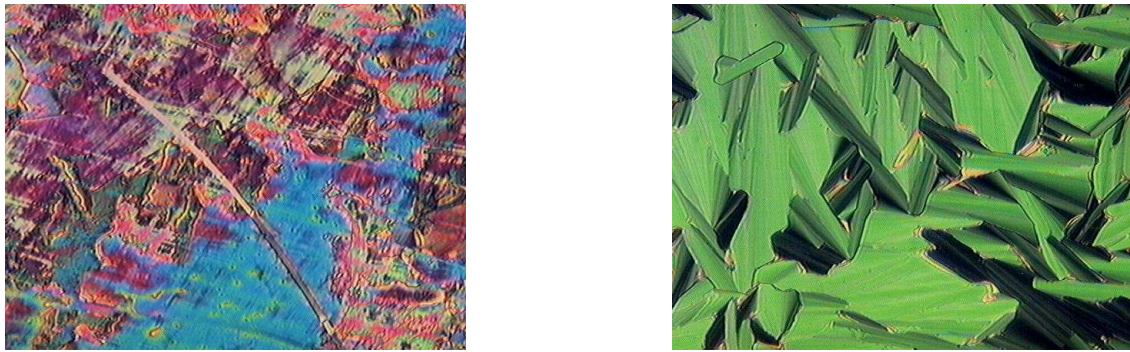
Abbildung 6.26. Texturen der Mischung A/F ( x_A = 30 Mol-%): Marmorierte Textur der nematischen Phase, 130 °C (a) und Mosaiktextur der kolumnaren Phase, 100 °C (b).
