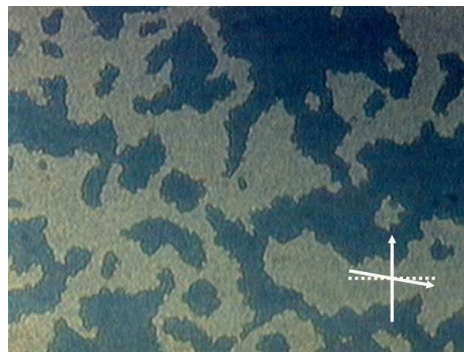
Abbildung 5.4. Optische Textur der Verbindung 17c , welche 2 K oberhalb der Klärtemperatur beim Anlegen eines elektrischen Feldes von E = 25\text{ V } \mu\text{m}^{-1} erhalten wird. Ein Polarisator ist um +5^\circ aus der gekreuzten Position gedreht.
