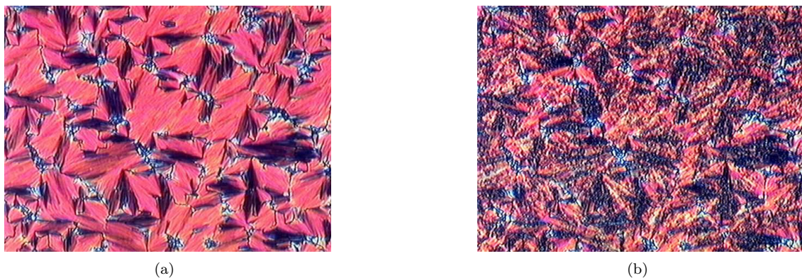
Abbildung 3.34. Texturen der Mesophasen von Verbindung 7c : Die Fächertextur der SmCP-Phase wurde beim Abkühlen der isotropen Flüssigkeit in Gegenwart eines elektrischen Wechselfeldes ( E = \pm 10\text{ V }\mu\text{m}^{-1} ; f = 500\text{ Hz} ) erhalten, 115\text{ °C} (a). Beim weiteren Abkühlen ohne Einwirkung eines elektrischen Feldes erscheint die B 7 -Phase deutlich wahrnehmbar unter Ausbildung einer grainy texture , 105\text{ °C} (b).
