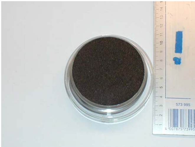
Abb. 19: Vorbereitete ungestörte Probe des Oberen Bitterfelder Glimmersands für KD-Versuch.
