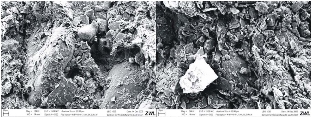
Abb. 69 a und b: REM-Aufnahmen der Probe BVV 0101. a (links): Mit Feinmaterial überzogene Sandkörner (20µm). b (rechts): Vergrößerung des Feinmaterials (10µm).
