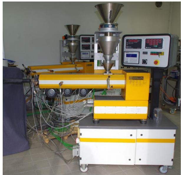
*Abbildung 48: Einschneckenextruder mit angeschlossenen Druckschläuchen*
