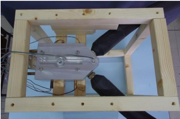
*Abbildung 47: Werkzeug im Versuchsaufbau mit angeschlossenen Druckschläuchen*
