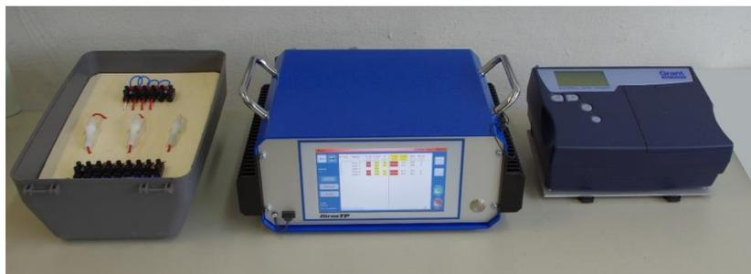
Abbildung 46: Kabelbox, Heißkanalregelgerät, Datenlogger (v.l.n.r.)
