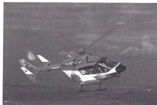
Abb. 3 ▶ Die BK 117 C1 ist mit zwei Turbomeca Arriel Triebwerken mit jeweils 708 PS ausgerüstet
