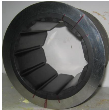
Abbildung A.2: Beispiel eines Stevenrohrs mit 175 mm Länge und einem Durchmesser von 150 mm [94].
