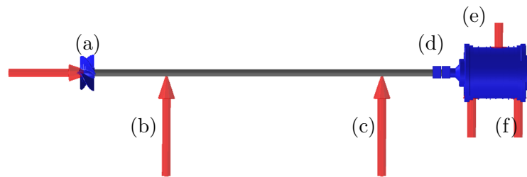
Abbildung 4.45: Modell des Antriebsstrangs des Gleitboots
