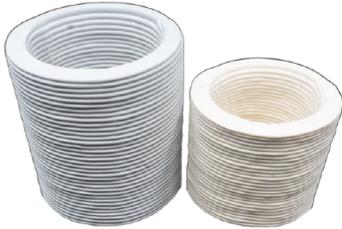
Abb. 18: links: Grünkörper, rechts: gesintertes Bauteil
