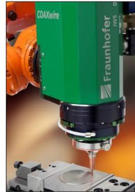
Bearbeitungsoptik COAXwire am Roboter
