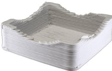
Abb. 19 Demonstrator einer Brennkassette
