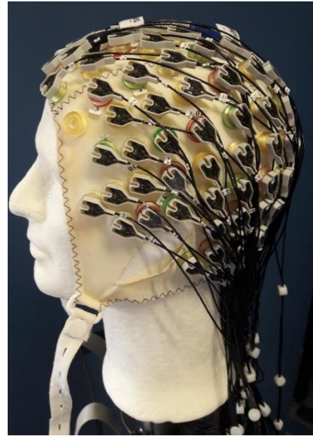
Abbildung 01: Verwendete EEG-Haube „actiCAP 128Ch Standard-2“, Brain Products GmbH
