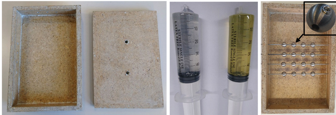
Abbildung 9: Links: Box für die Herstellung der Schaumplatten, mittig: Zweikomponentensystem FlexFoam-iT III, rechts: Anordnung der metallischen Einschlüsse
