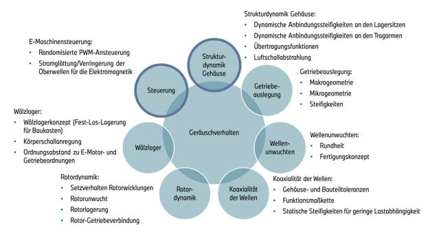
Abbildung 7: Einflussfaktoren auf das Geräuschverhalten eines elektrischen Antriebs
