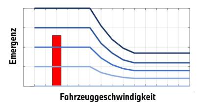
**Abbildung 2:** Wahrnehmbarkeitsabstufung zur Emergenz in 5 Stufen von stark wahrnehmbar (Dunkelblau) bis nicht wahrnehmbar (Hellblau)
