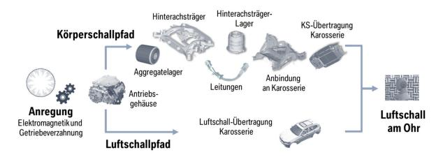
Abbildung 4: Die Wirkkette der Antriebsakustik von elektrischen Fahrzeugantrieben
