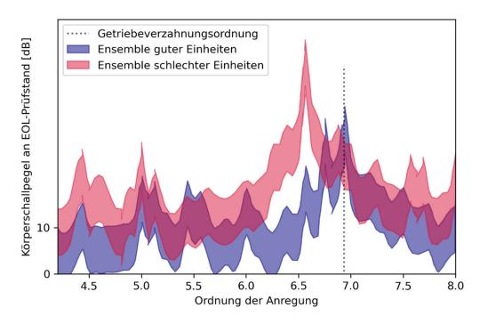
**Abbildung 13:** Auswirkung einer welligen Verzahnungsoberfläche im Vergleich zu einem Ensemble akustisch guter Maschinen. Als Referenz ist die normale Zahneingriffsordnung notiert
