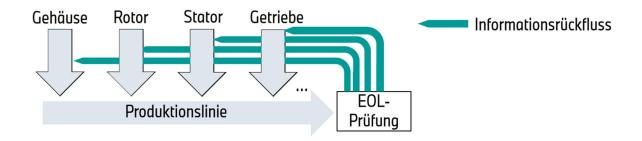
**Abbildung 12:** Aufbau der Produktionslinie, sowie Datenrückschlüsse auf Basis von EOL Körperschallmessungen
