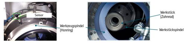
Abbildung 14: Schwingungsüberwachung bei dem Honprozess
