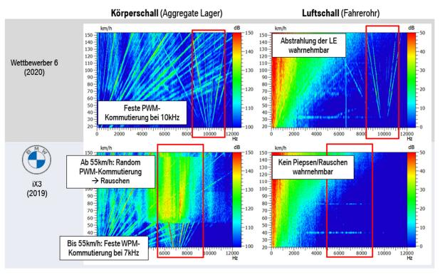
**Abbildung 9:** Einfluss PWM-Schaltmuster auf Körperschall vor Aggregatlager und Luftschall im Innenraum. Vergleich der direkten Raumzeiger-Modulation RZM (Fahrzeug eines Wettbewerbers) und Kombination von RZM mit Random-PWM (BMW iX3)
