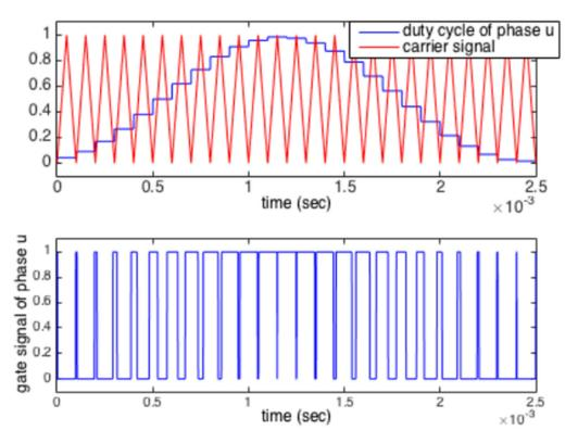
Abbildung 8: Beispiel einer symmetrischen, regelmäßigen Abtastung mit Trägerfrequenz aus [6]
