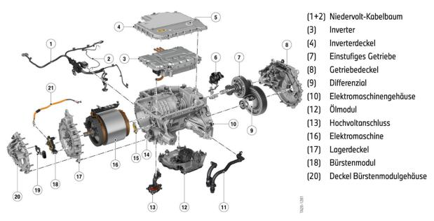
Abbildung 5: Elektromotor, Getriebe und Inverter sind in einem gemeinsamen Gehäuse integriert
