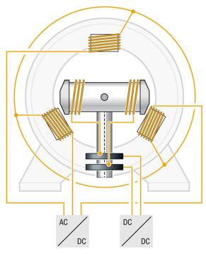
Abbildung 6: Konzeptschaubild einer stromerregten Synchronmaschine
