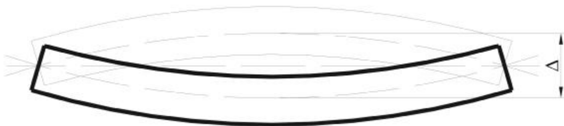
Bild 2.5: Biegung der Rolle
