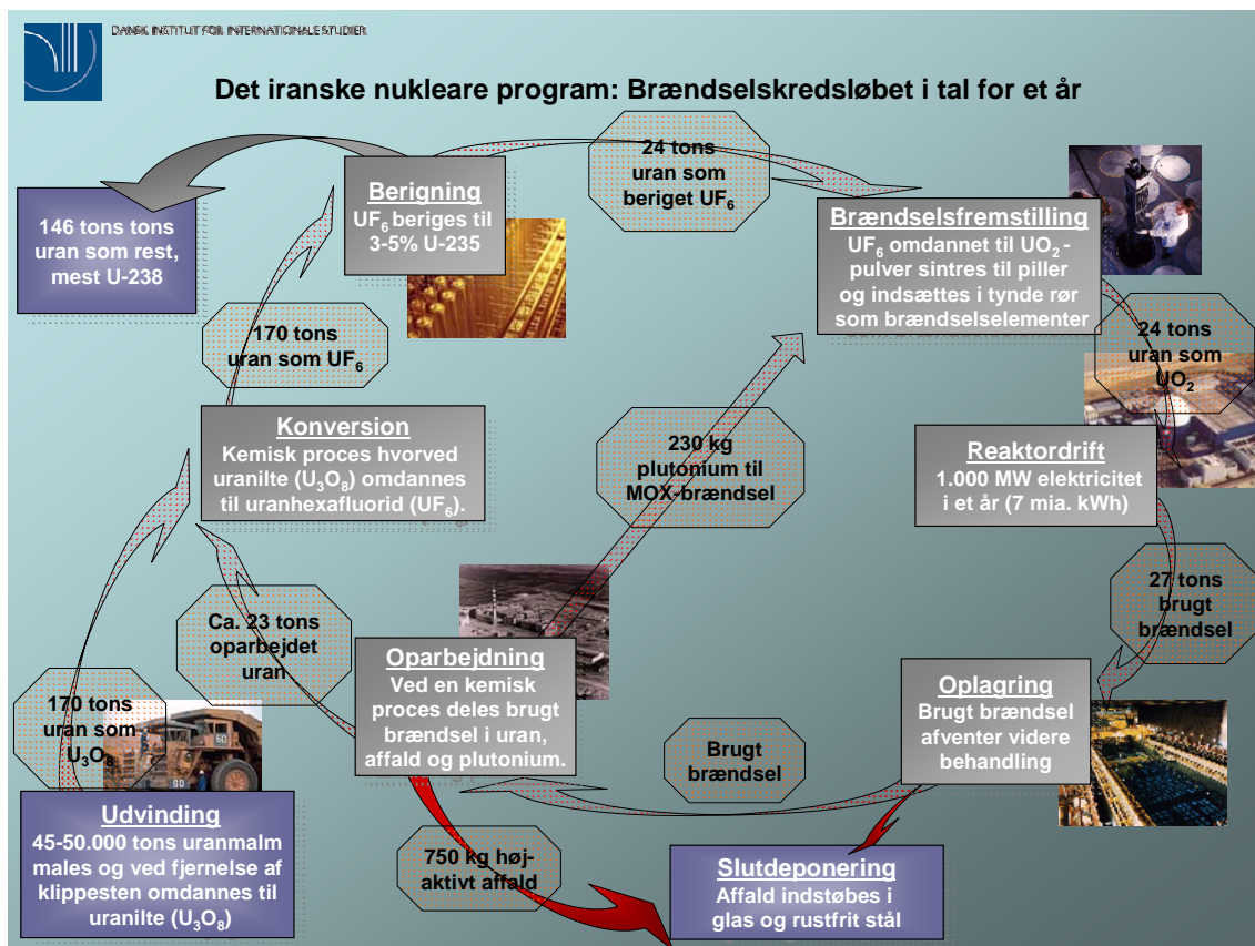
Figur 11. Brændselskredsløbet i en civil reaktor med et taleksempel for et års drift.
