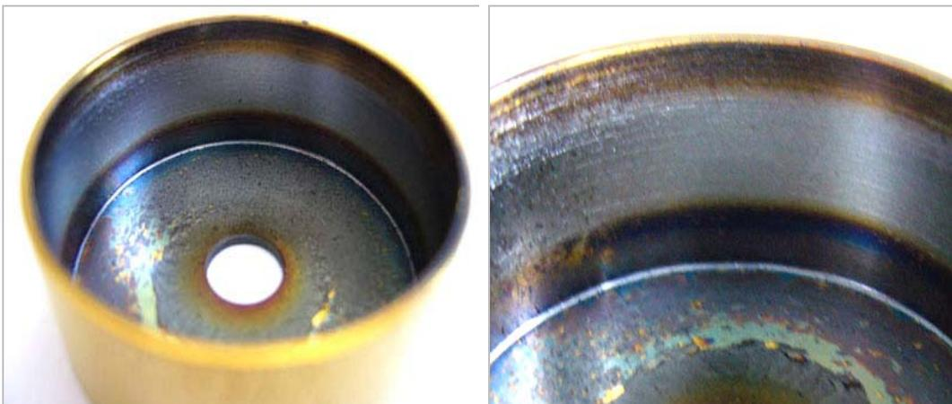
**Abbildung 6.52:** Links: Schwach kontaminierte Messkammer der langzeitgetesteten Messröhre. Auf der inneren Manteloberfläche des Messkammerzylinders erkennt man einen hellen Sputtererosionsring. Rechts: Ca. 2,5fach vergrößerte Darstellung.
