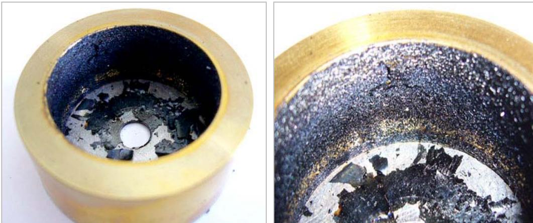
**Abbildung 6.51:** Links: Stark kontaminierte Ionenbafflekammer der langzeitgetesteten Messröhre. Auf der inneren Manteloberfläche des Kathodenzylinders 1 erkennt man deutlich eine dicke, nahezu geschlossene Kontaminationsschicht. Rechts: Ca. 2,5fach vergrößerte Darstellung der auf der Zylinderelektrodenoberfläche abgeschiedenen Kontaminationsschicht.
