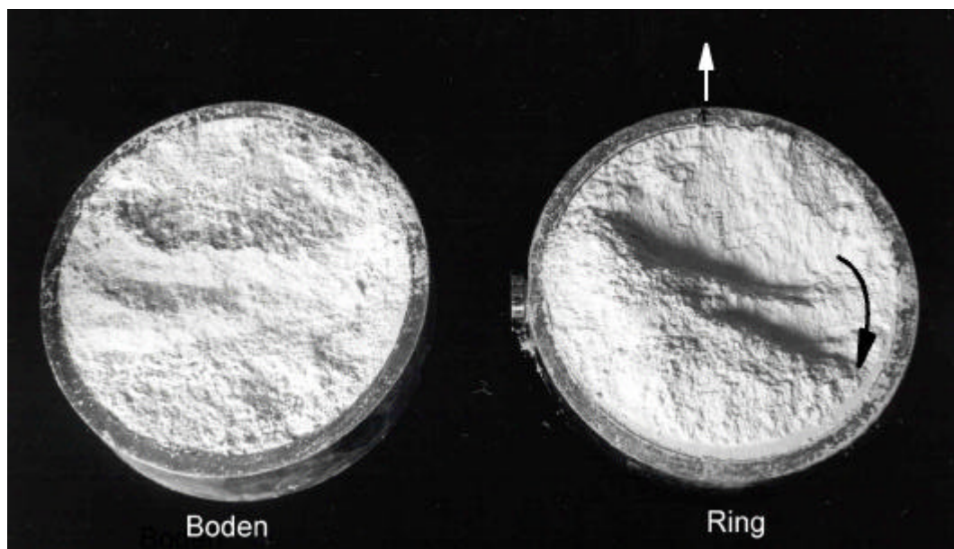
Abb. 8.2: Veränderungen der Bruchfläche bei hohen Schwingwegen ( \text{CaCO}_3 ; 1,3 \mu\text{m} )
