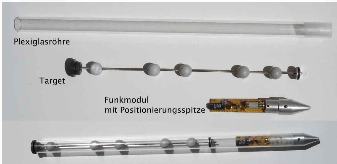
Bild 5-19: Interaktionsstift – Bauteile [SCH05]
