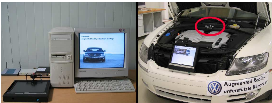
Bild 5-2: Trackingrechner und WebPad (links); Montiertes Target für Tracking (rechts)
