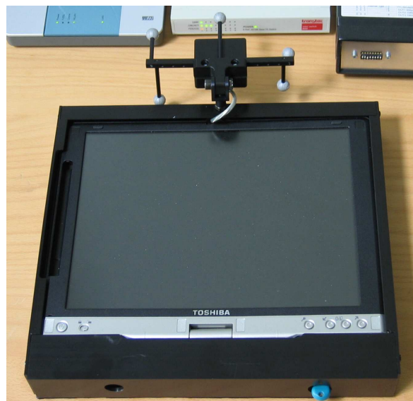
Bild 5-3: WebPad mit angebaute USB-Kamera
