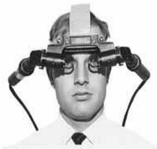
Bild 2-1: Erstes "see-through" 3D HMD [SUT68]
