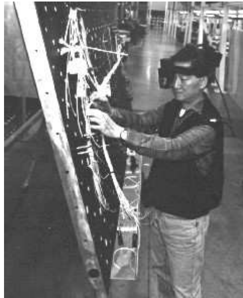
Bild 2-5: Dr. David Mizell bei der Kabelbaum-verlegung mit Hilfe von Augmented Reality [VAL99]
