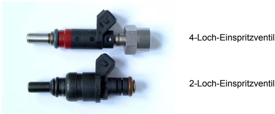
**Abbildung 4-52:** Graphische Darstellung des 4-Loch- und 2-Loch-Einspritzventils
