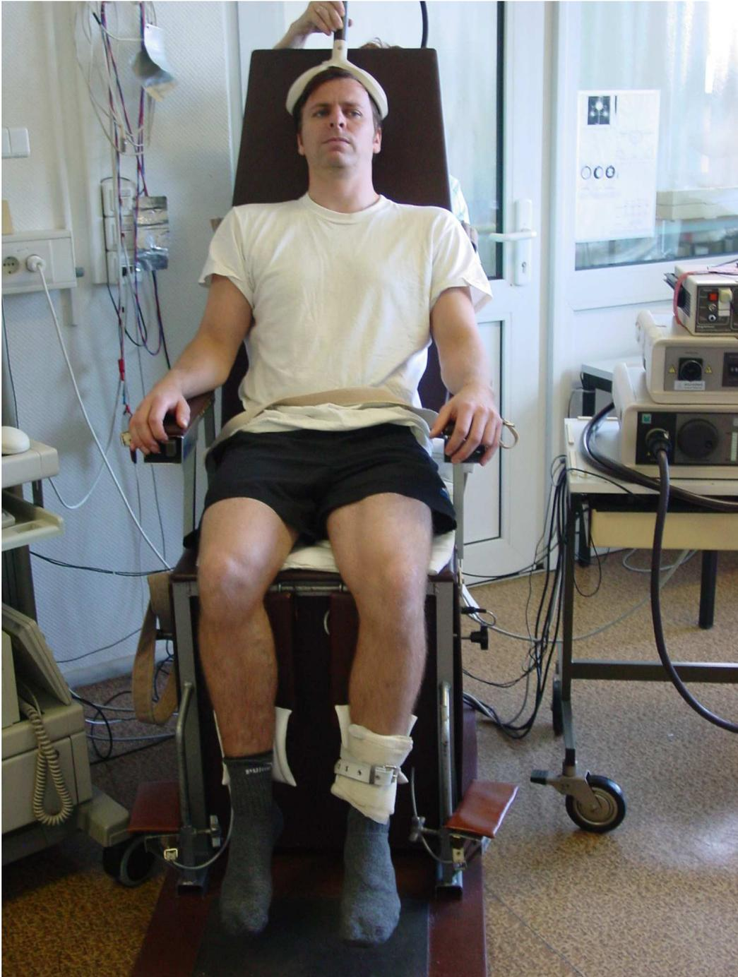
Abb. 21: Proband, der mit einer konischen Doppelpule stimuliert wird, während er eine isometrisch maximal willkürliche Kontraktion (MVC) auf dem Kraftmessstuhl ausführt. Das dabei entstehende maximale Drehmoment wird über einen Dehnmessstreifen, der sich im Gerät befindet, gemessen. Dieses Kraftsignal wird mit einem Analogverstärker zum Dantec Counterpoint gesendet, der als Datenaufnahmeggerät für die Drehmomentwerte dient.
