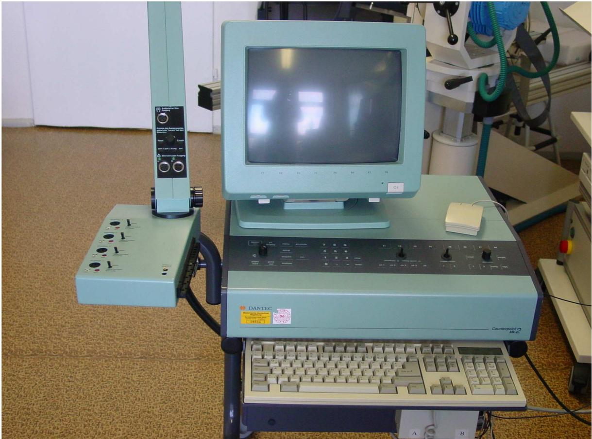
Abb. 17: Der Dantec Counterpoint MK 2 (Skovlunde, Dänemark) der als Datenaufnahmegesetz für die EMG und Drehmomentwerte sowie als Datenverarbeitungscomputer und Stimulator dient.
