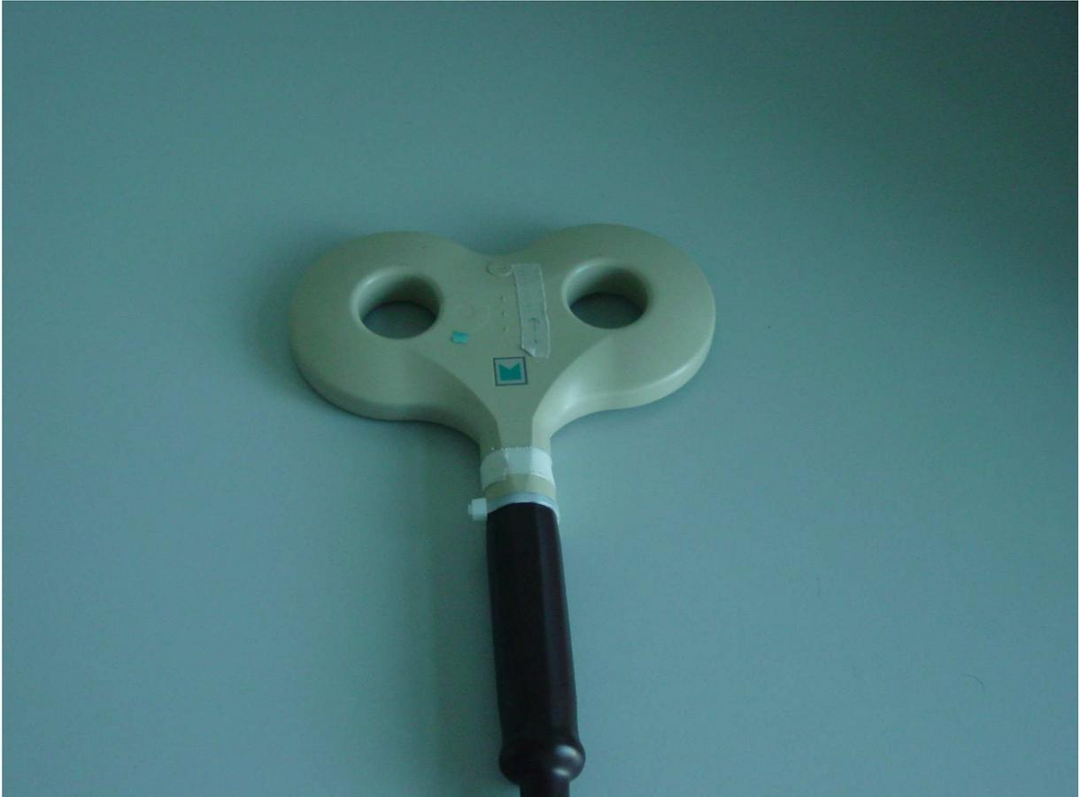
*Abb.10: Die Achterspule zur transkraniellen Magnetstimulation des Motorkortex und der peripheren Nerven*
