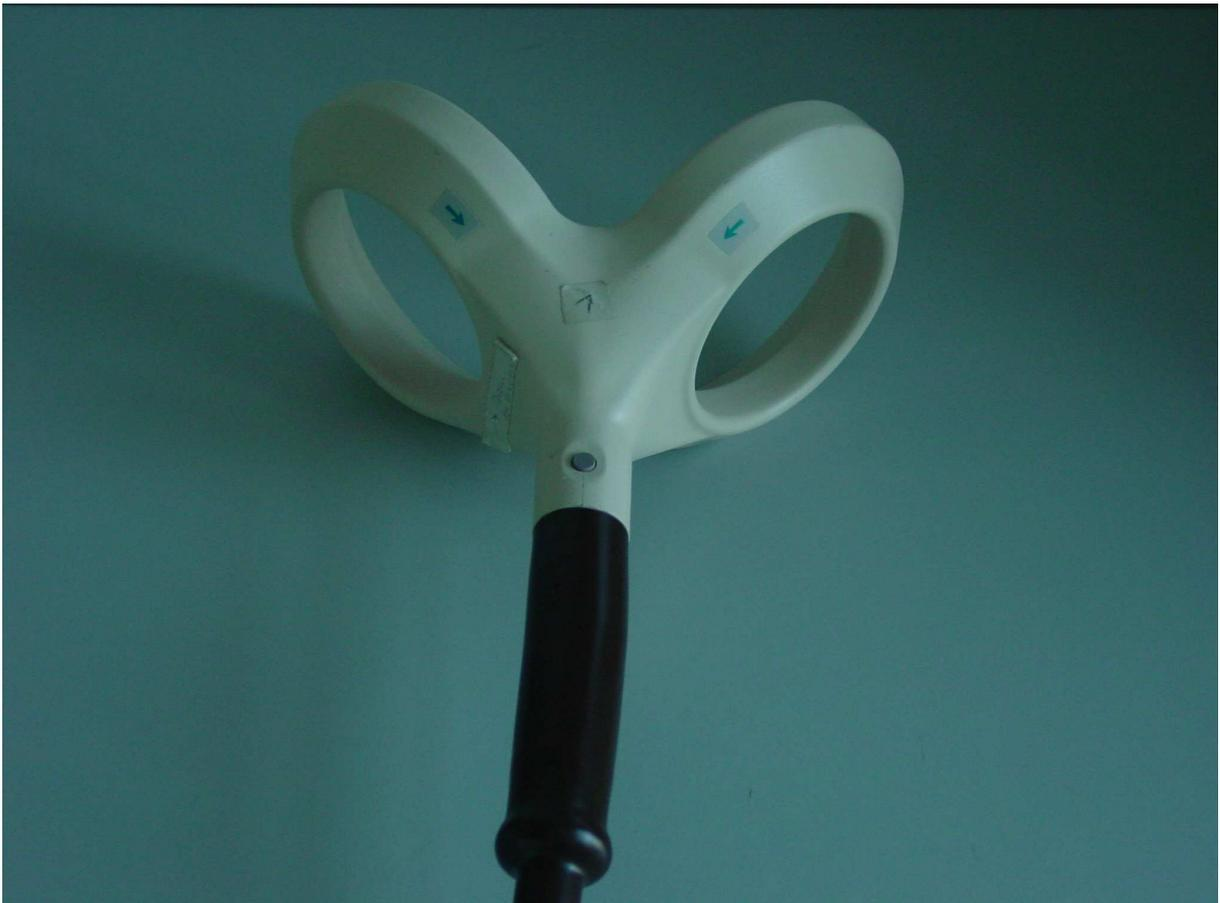
Abb.11: Die konische Doppelspule zur transkraniellen Magnetstimulation von zentralen motorischen Nerven
