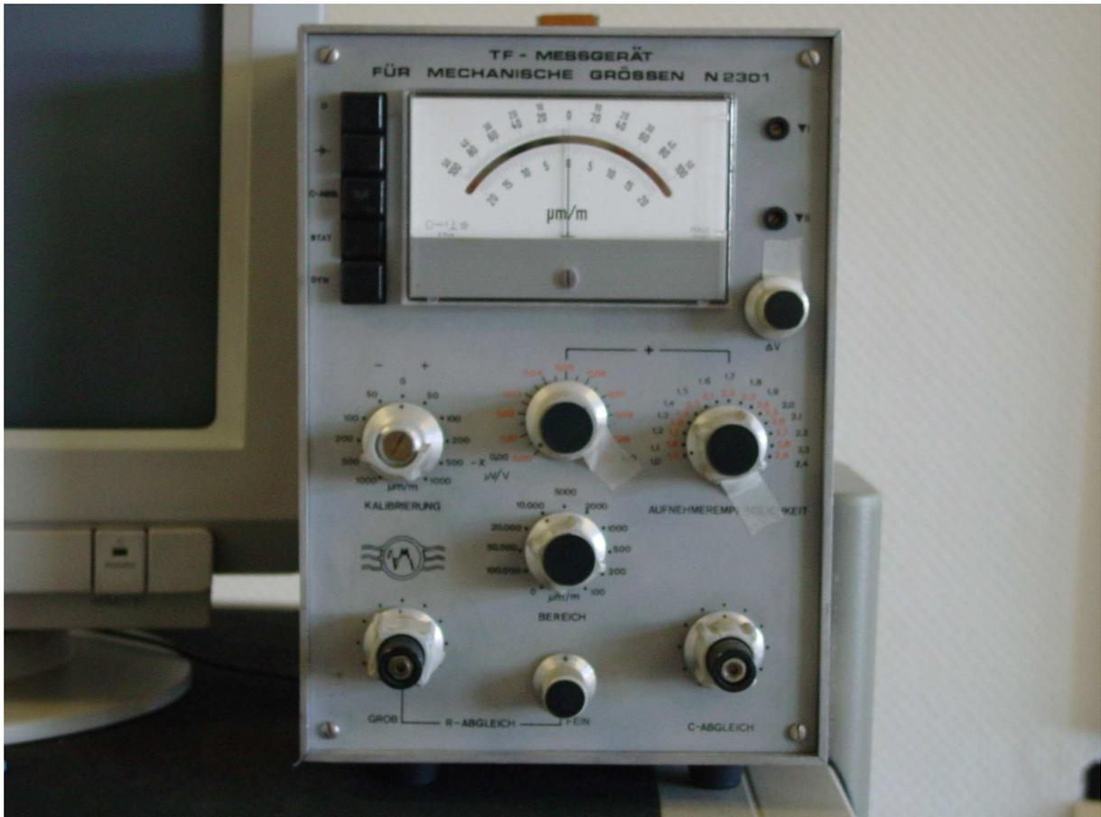
Abb. 18: Analogverstärker für das Kraftsignal des Dehnmessstreifens (TF – Messgerät N2301)
