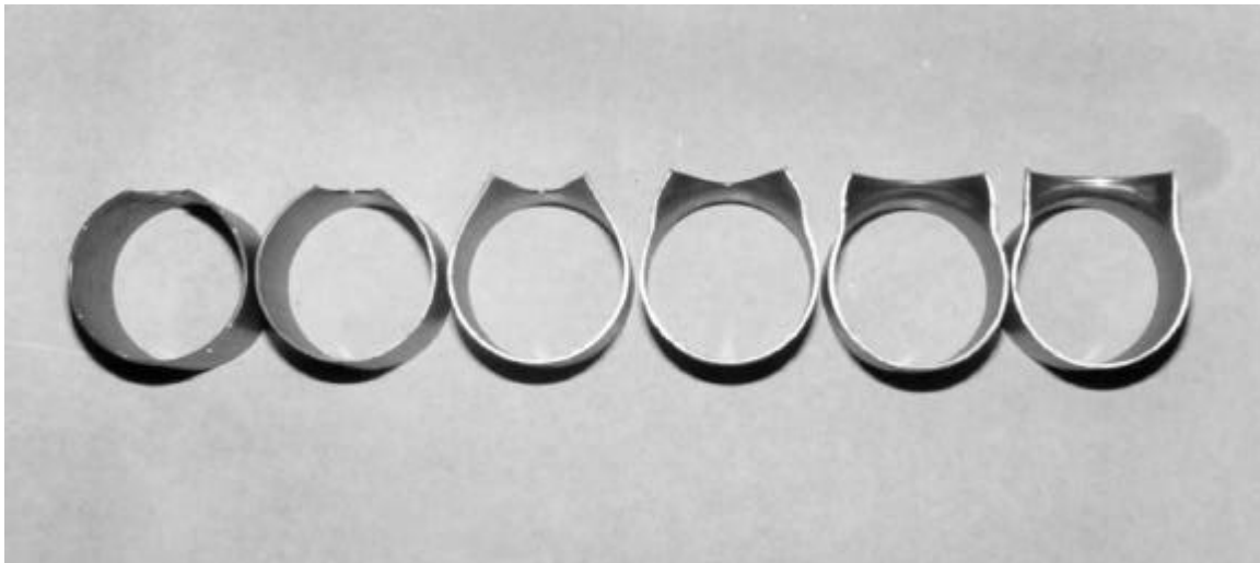
Bild 5.2: Umformstadien des Aushalsprozesses (Kegelstempel)
