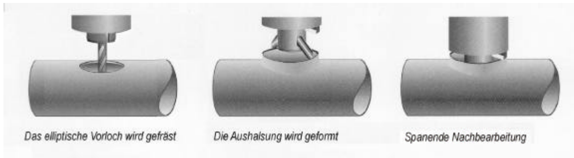
Bild 2.1: Prozessstufen des T-Drill-Verfahrens [17]
