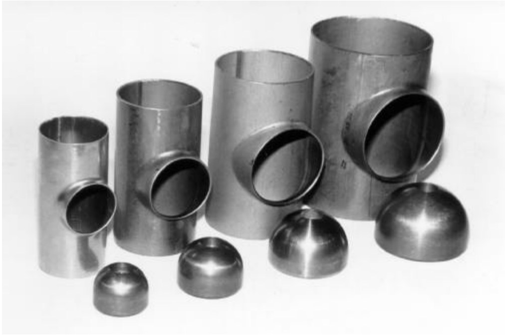
Bild 4.13: Rohraushalsungen d_A/d_R = 0,8 mit dazugehörigen Aushalsstempeln
