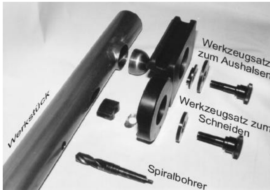
Bild 4.3: Schneid- und Aushalswerkzeuge für das Rohraushalsen
