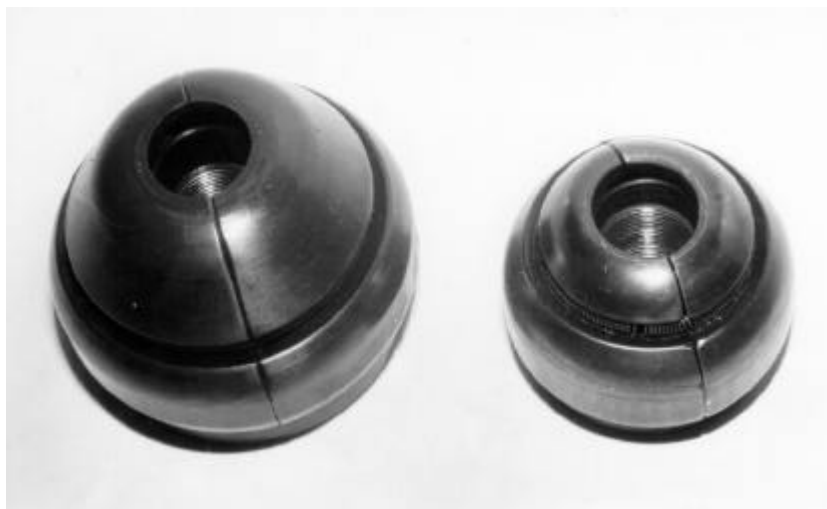
Bild 4.4: Spreizkegelwerkzeuge für Rohraushalsungen der Abmessung d_A/d_R = 1
