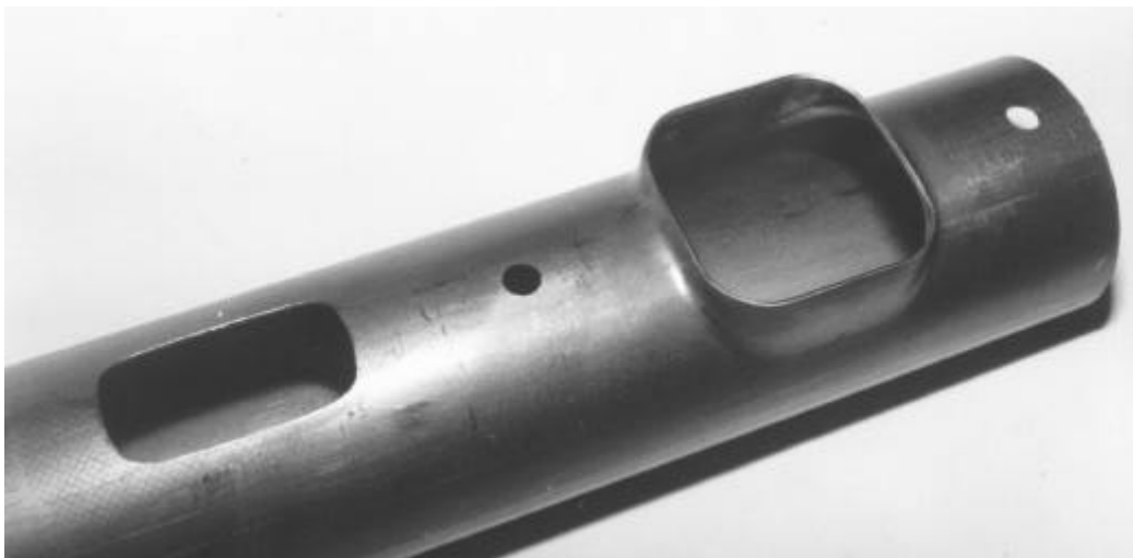
Bild 4.14: Quadratische Aushalsung und dazugehörige Ausgangsöffnung
