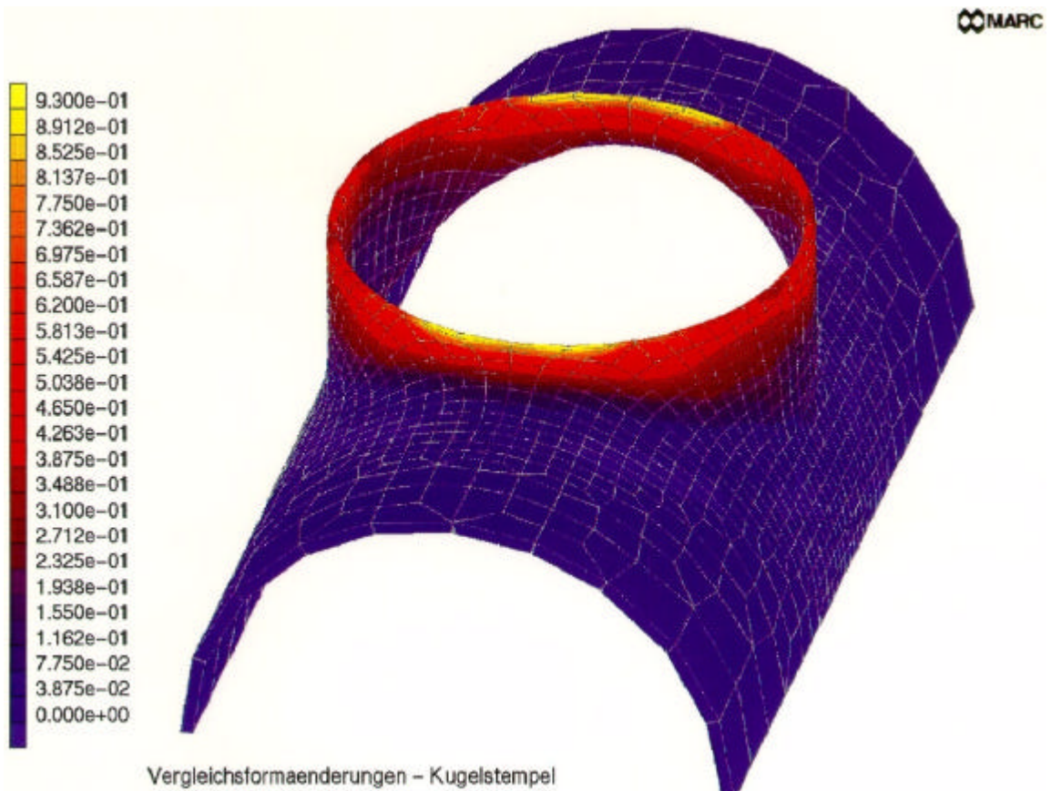
Bild 5.5: Mit der FEM berechnete Vergleichsformänderungsverteilung
