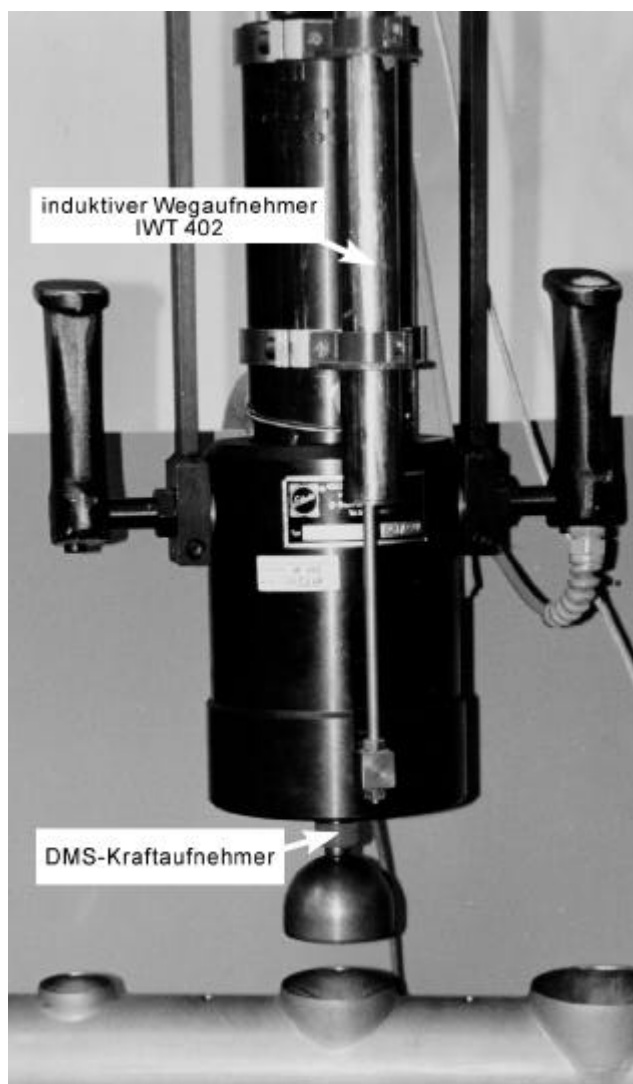
Bild 4.7: Sensoren an der Umformmaschine
