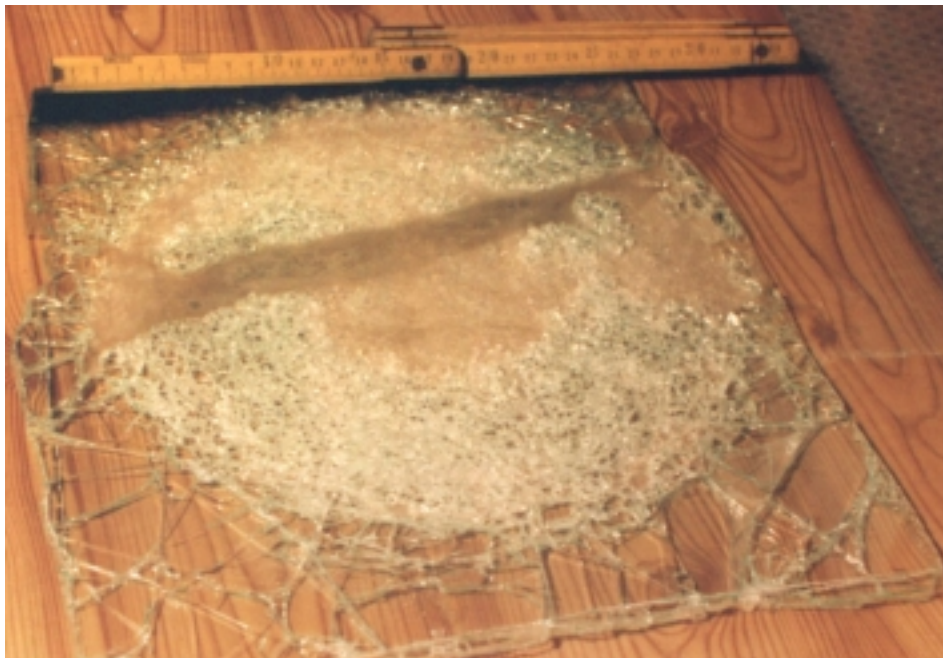
Bild 7.2.3. Verbundglas nach der Belastung mit Leistungsschallimpulsen
