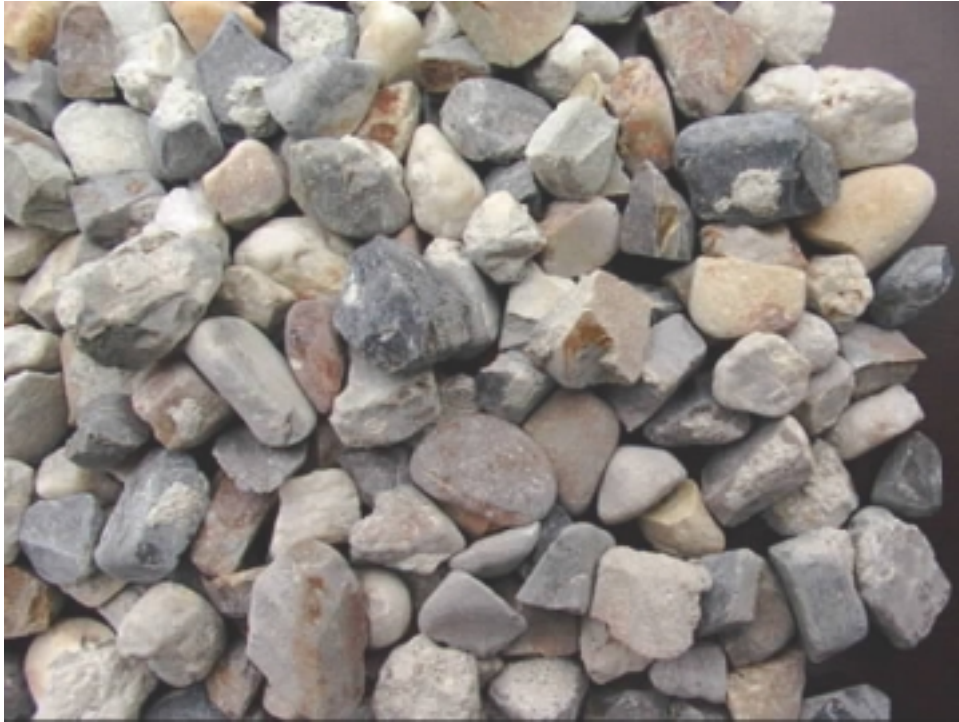
Bild 7.1.19. Zuschlagskörner nach der Leistungsschallimpulsbearbeitung
