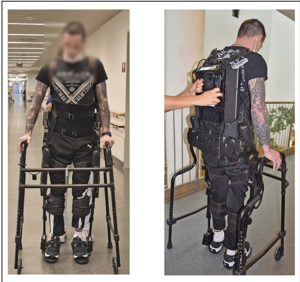
Abbildung 5: Steuerungsmöglichkeiten der auszuführenden Bewegungen durch Gewichtsverlagerung und durch LCD-Steuerung auf dem Rücken der Person
