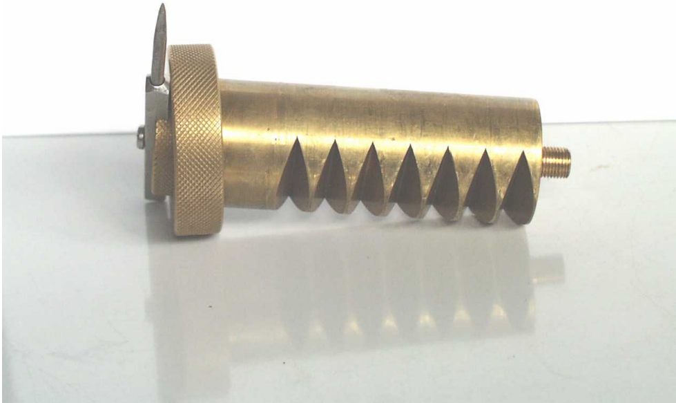
Abb. 7.3: Walze mit V-förmigem Schlitz
