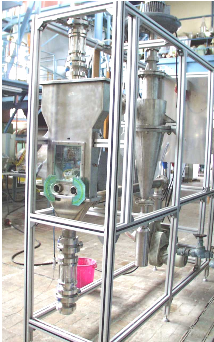
Abb. 7.2: Versuchsanlage DN 100 mobil
