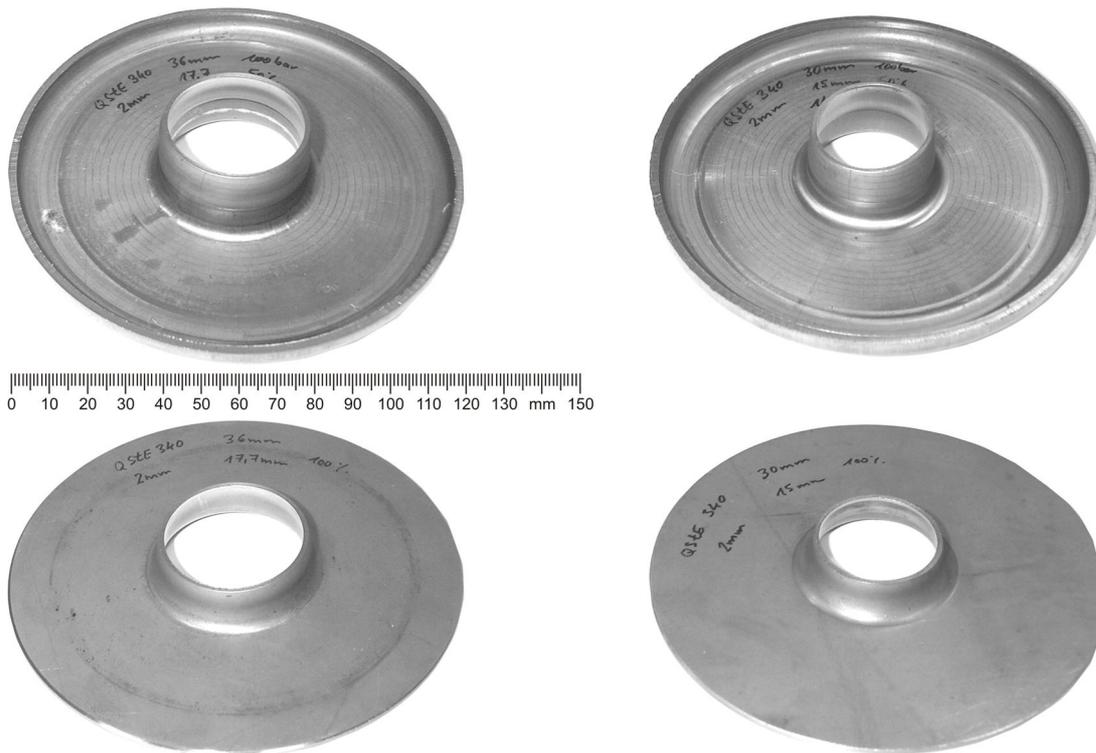
Bild 8-3: Realteile; oben, Kragenziehen mit Nachschieben von Werkstoff und definiertem Werkstofffluss; unten konventionelles Kragenziehen; (Blechdicke: 2 mm, Werkstoff: QStE 340, Nachschiebe-Ziehverhältnis: links 3,3; rechts 4,0; Maßstab: 1:2).
