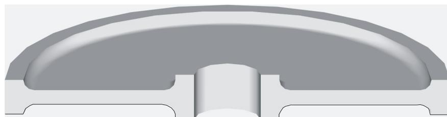
3. Stufe Erzeugung beidseitiger Materialanhäufungen mittels Durchsetzen
