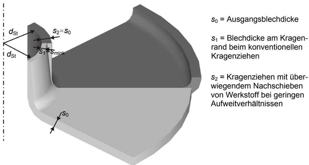
Bild 7-21: Vergleich konventionelles Kragenziehen mit dem Kragenziehen mit überwiegendem Nachschieben von Werkstoff bei geringen Aufweitverhältnissen.
