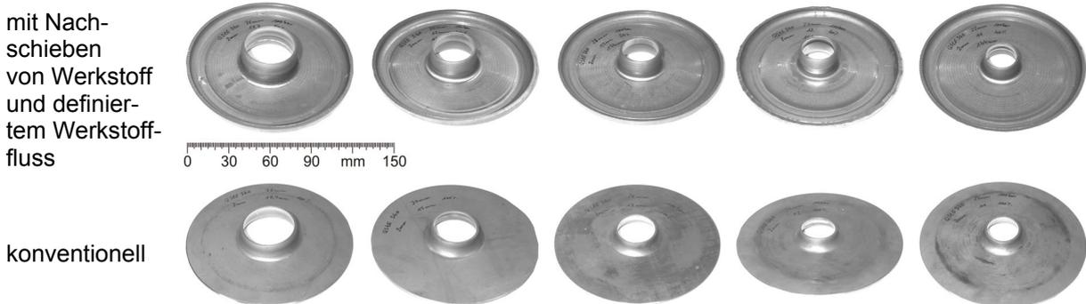
Bild 7-2: Vergleich konventionelles Kragenziehen - KNWW. (Werkstoff: DC 01, Blechdicke: 2 mm)
