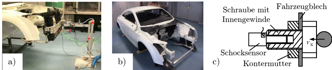
Abbildung 4.13: a) und b) Versuchsaufbau und Durchführung von Impulsgenerator tests, c) Aufbau der Impulsmessung
