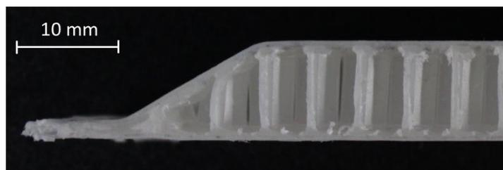
Abb. 55: Querschnitt eines pressgeformten Randabschlusses unter Anwendung des einstufigen IR-Aufheizprozessschritts mit zwischengeschalteter Abschirmphase
