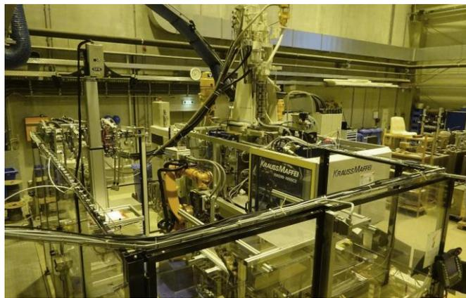
Abb. 93: Erweiterte Pilotanlage für das Thermoformspritzgießen von FKV-Sandwichbauteilen
