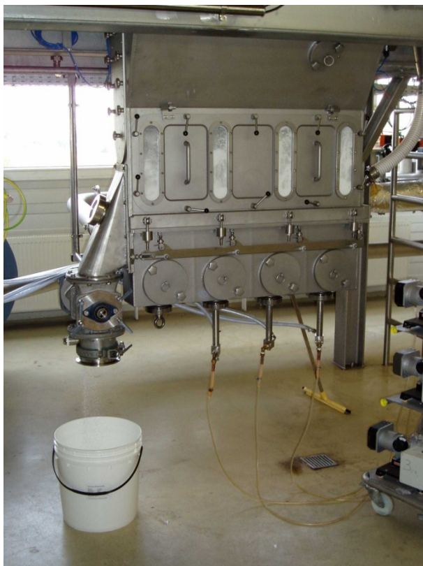
Abbildung 2-31: Teilansicht des Prozessraumes der Pilotanlage GF 20 (Hersteller: Glatt Ingenieurtechnik GmbH, Weimar)
