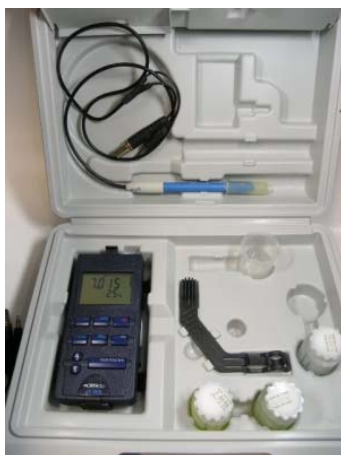
Abbildung 3-4: Messgerät WTW Typ pH 340 (Hersteller: WTW, Weilheim)
