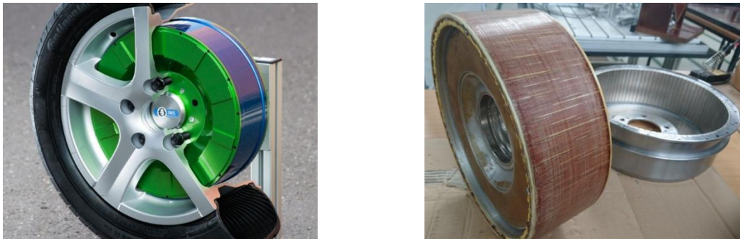
Bild 1: Prototyp mit Felge „Elisa Radnabenmotor“ (links) sowie Stator mit der Luftspaltwicklung und Rotor mit Magneten (rechts)
