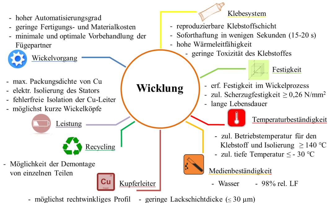
Bild 6: Komplexes Anforderungsprofil an die Luftspaltwicklung
