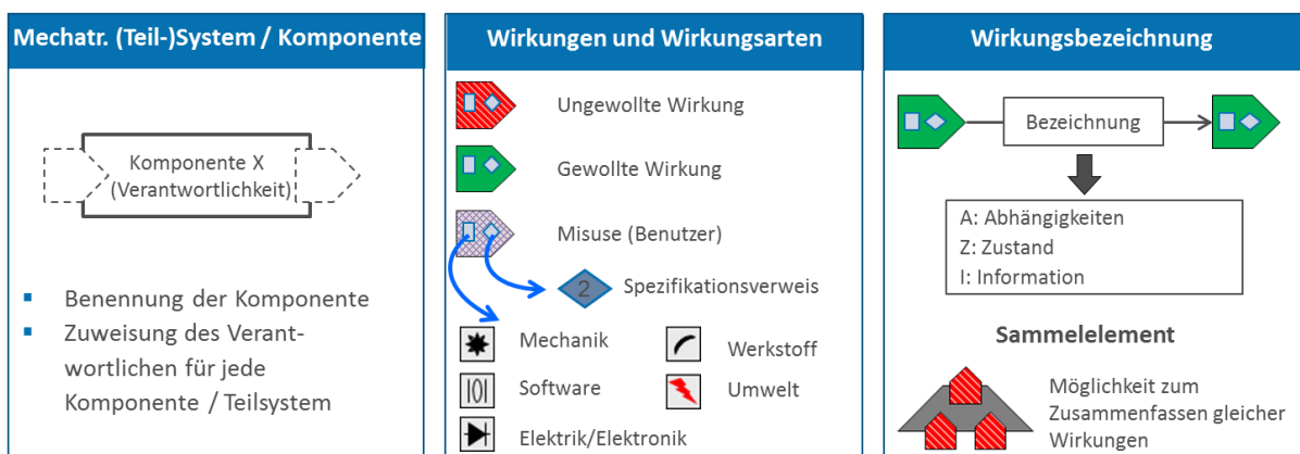
Abbildung 3: Elemente der Wirkkettenmodellierung und -analyse.
