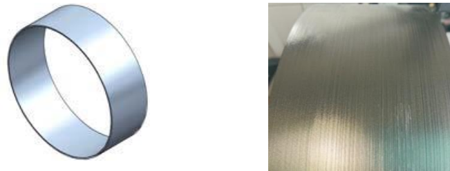
Bild 4: Eisenrückschluss des Stators: Schematische Darstellung (links) und Originaldarstellung (rechts)
