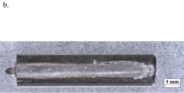
Bild 5: Querschliff (links) und Draufsicht (rechts) auf ein Aluminiumblech verschweißtes Drahtelement
