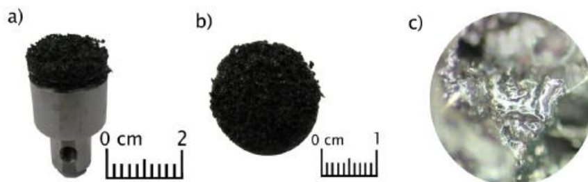
Bild 6: a) Schleifkörper b) Schleifkörper Draufsicht c) Schleifstoff in 50-facher Vergrößerung
