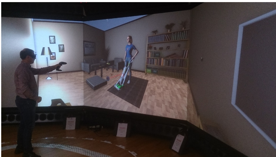
Abbildung 8: Visualisierung des derzeitigen VR-Systems innerhalb einer 3-Seiten-CAVE
