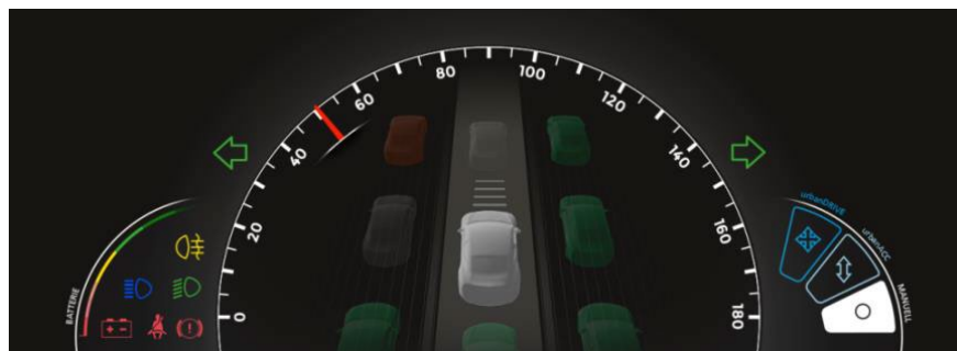
Abbildung 9: Generischer Aufbau des urbanDRIVE Kombidisplays mit Neuner-Schema in der Mitte
