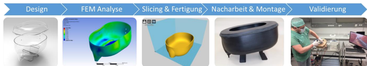
Abb. 4: Prozessschritte bei der Entwicklung des Prototyps. Zu Beginn steht die Konstruktion des Bauteils, dessen Verhalten anschließend in unterschiedlichen Lastfällen simuliert wird. Die Fertigungsvorbereitung mittels Slicing-Software und händische Nacharbeit am physischen Modell folgendes daraufhin. Zuletzt wird der Prototyp auf seine Funktionalität überprüft.
