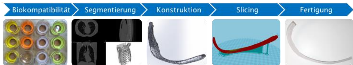
Abb. 6: Entwicklungsprozess eines patientenspezifischen Thoraximplantats. Die Biokompatibilität des Werkstoffs ist essentiell bei der Auswahl des geeigneten Materials. Anschließend folgt die Segmentierung der CT-Daten, die Konstruktion, das Slicing und zuletzt die Fertigung (v.l.n.r.)
