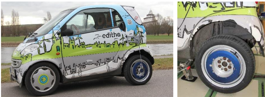
Bild 1: (a) Elektrosmart „Editha 1“ mit montiertem Messrad, (b) Detailaufnahme Messrad
