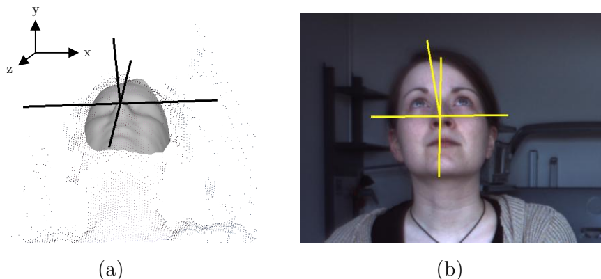
Abbildung 5-4: Beispiel der stereobasierten ICP Poseschätzung, (a) ausgerichtetes Modell, (b) Projektion der aktuellen Pose auf das Bild.
