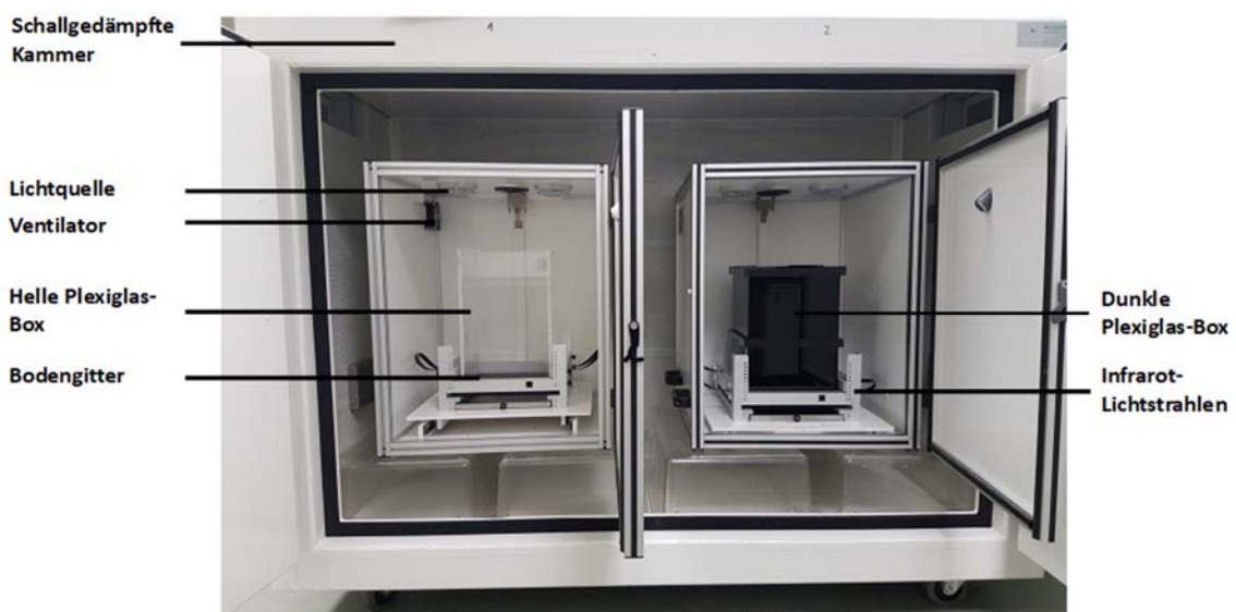
Abbildung 6: Konditionierungsapparatur zur Untersuchung des kontextuellen Furchtlernens, sowie des Extinktionslernens von signalvermittelter Furcht.
