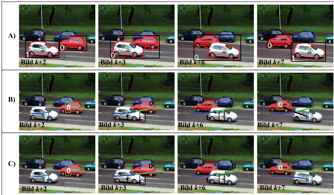
**Abbildung 5-4-2d:** Objektverfolgung mit dem Partikelfiltersystem für eine einfache Verkehrsszene. A) Bewegungsegmentierung mit dem MD-Ansatz. B) Trajektorien des Partikels mit dem größten Likelihood-Wert. C) B-Spline geglättete Trajektorien des Partikels mit dem größten Likelihood-Wert.
