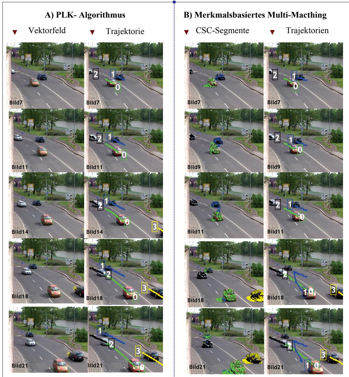
**Abbildung 8-6-1a:** Die Konfliktsituationen in dieser Szene bestehen darin, dass die MB der entgegenkommenden PKW verschmelzen und wieder getrennt werden müssen. Multi-Objektverfolgung der Szene 3 mit dem PLK-Algorithmus (A) und mit dem merkmalsbasierten Verfahren auf der Grundlage von CSC-Segmenten.
