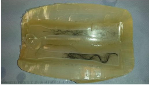
Bild 49: Silikonform für Proben L1 und L2
