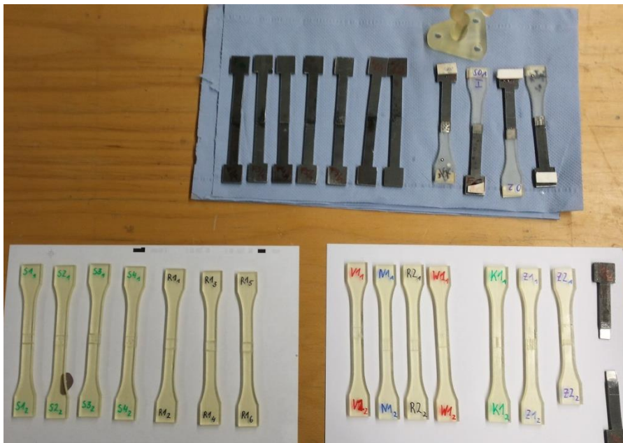
Bild 81: Verklebte Proben und Haken
