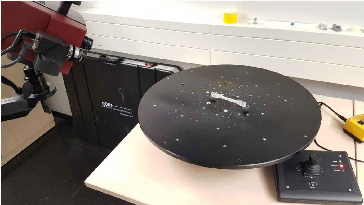
Bild 56: 3D-Scanner mit Drehtisch und Referenzpunkten
