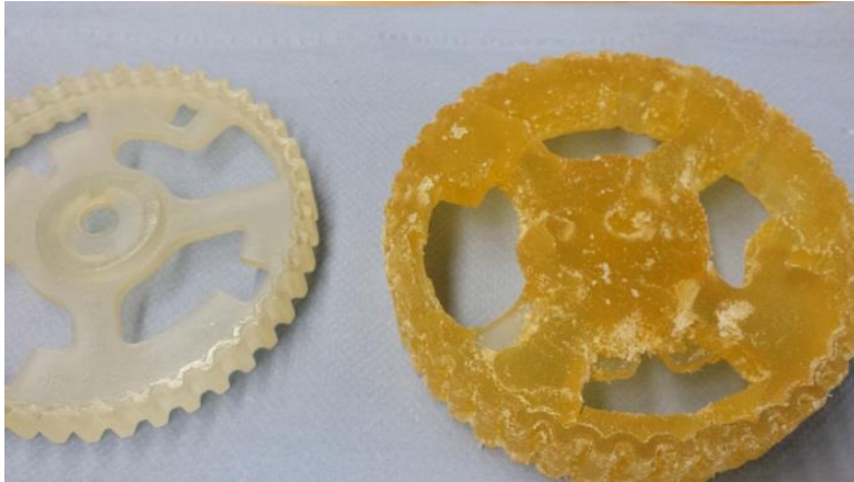
Bild 11 : Poly Jet Bauteil mit wasserlöslicher Stützstruktur
