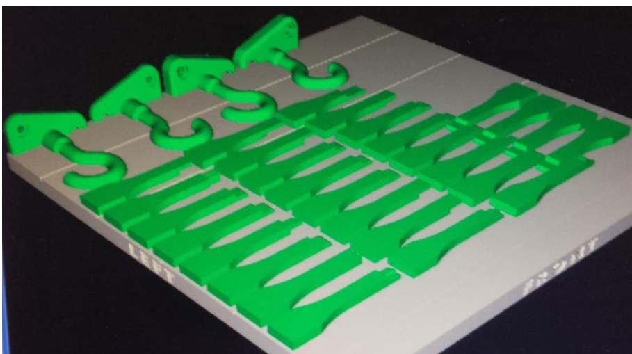
Bild 80: Bauplattform mit den Proben der 4. Reihe und vier halben Kleiderhaken
