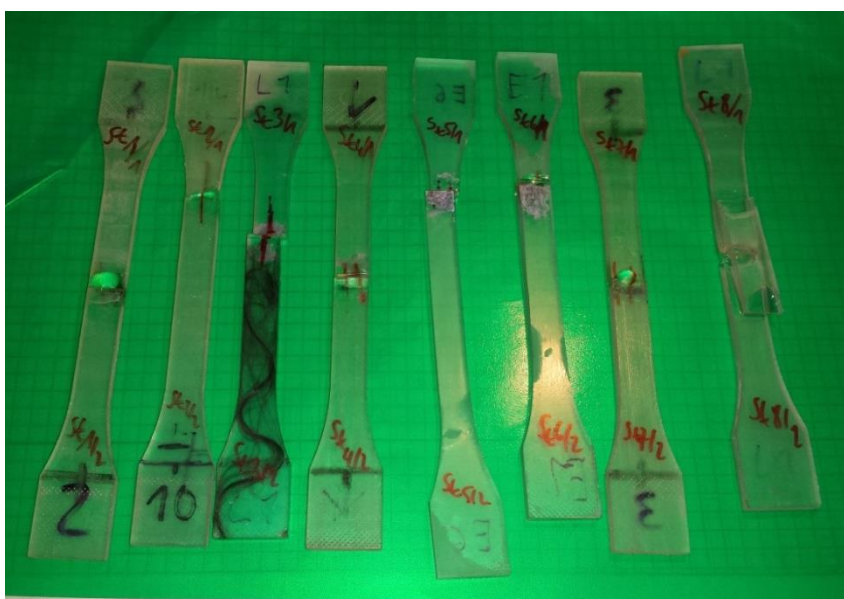
Bild 70: wieder verklebte Proben der St-Reihe
