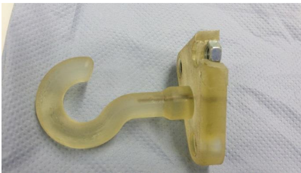
Bild 90: Kleiderhaken mit eingeklebter Stahlmutter und Stahldraht
