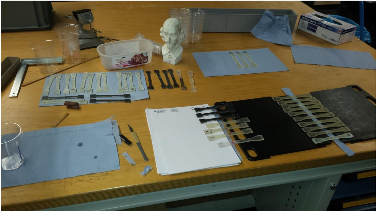
Bild 65: Probenvorbereitung für die 3. Versuchsreihe
