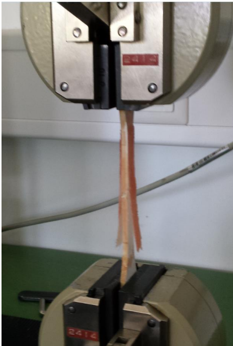
Bild 35: Spannfutter mit Zugprobe
