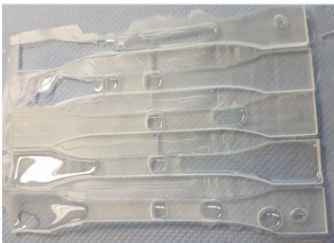
Bild 47: fehlerhafte Proben aus Epoxidharz
