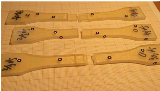
Bild 67: Versagensstellen der Proben Sp1, Sp3 und Sp4
