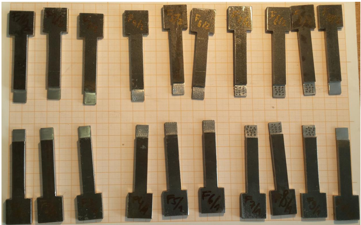
Bild 76: Metallproben mit unterschiedlichen Oberflächenrauheiten
