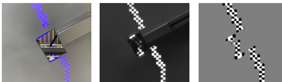
Abbildung 64: Spiegelnde Objekte unterscheiden sich bzgl. der Detektierbarkeit nicht von anderen opaken Objekten. Die Schutzraumeindringung (links) führt zu einer Unterbrechung der Emissions- oder Reflexionsstrahlen im Kamerabild (Mitte), was in einer Abweichung zwischen ^AZ (rechts) und zugehörigem ^EZ resultiert.
