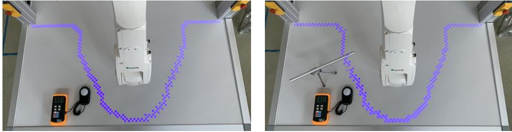
Abbildung 65: Überwachung eines statischen Schutzraumes ohne Objekteintrittung (links) und mit Eindringung (rechts) eines Objektes (14 mm Durchmesser). Die vorliegende Beleuchtungsstärke E_v wird mit dem Luxmeter eurolite® LM-200 unmittelbar neben dem Schutzraum gemessen.
