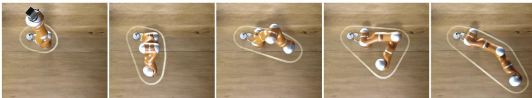
Abbildung 39: Darstellung fünf spezifischer Roboterkonfigurationen mit resultierender Schutzraumsequenz. Schutzraumsequenz umschließt den Roboter als konvexe Hülle minimal.
