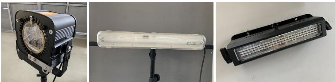
Abbildung 66: Beleuchtungseinrichtungen zur Änderung der Beleuchtungsstärke in der Umgebung. Links: Halogenlampe (HEDLER® H25s), Mitte: Leuchtstoffröhre (OSRAM® Lumilux). Rechts: LED-Stroboskop (cameo® THUNDER).
