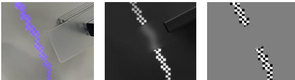
Abbildung 63: Die Unterbrechung der Reflexionsstrahlen durch ein transluzentes Objekt (links) führt zu einer diffus gestreuten und somit unscharfen Abbildung der codierten SRR im Kamerabild (Mitte). Somit ist keine eindeutige Extraktion der SRR und entsprechender Codes im AZ (rechts) möglich. Das AZ stimmt nicht mit dem EZ überein.
