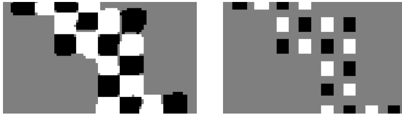
Abbildung 74: Links: Extraktion der SRR (Größe von 10\text{ mm} \times 10\text{ mm} ) im ^AZ mit einer Größe von 9(\pm 1) \times 9(\pm 1) Bildpunkten. Zwischen benachbarten Regionen existiert ein Totbereich \psi_a = 1(\pm 1) Bildpunkten. Rechts: Die zugehörigen SRR im ^EZ mit einer Größe von 5(+1) \times 5(+1) Bildpunkten und einem Toleranzbereich \psi_t = 3(+1) Bildpunkten zwischen benachbarten Regionen zur Steigerung der Robustheit.
