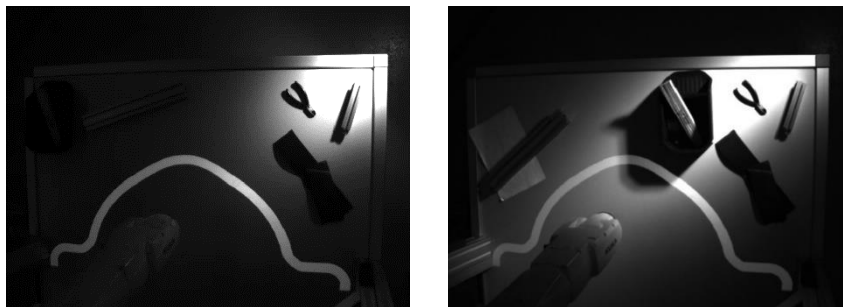
Abbildung 45: Kamera-Intensitätsbilder des Überwachungsbereiches mit darin befindlichen Objekten (Werkzeuge, Werkstücke) und Glanzlicht bzw. Schatten aufgrund von Fremdlicht. Die weiße Schutzraum-Linie trennt den Roboter-Arbeitsbereich/Gefahrenbereich (untere Bildhälfte) vom Arbeitsbereich des Menschen (obere Bildhälfte). Rechts: Die Position einzelner Objekte und die Beleuchtung ändern sich gegenüber dem linken Bild.
