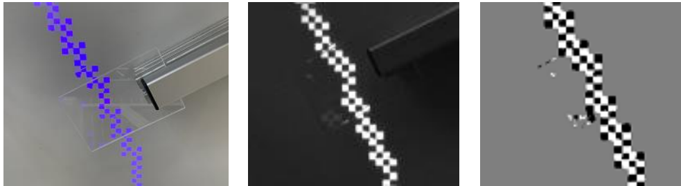
Abbildung 62: In den Schutzraum eindringendes, transparentes Objekt (links) führt zu keiner Unterbrechung der Emissions- oder Reflexionsstrahlen im Kamerabild (Mitte). Das resultierende AZ (rechts) stimmt mit dem entsprechenden EZ überein.
