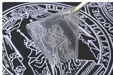
**Abbildung 3.1.:** Herstellung der Polymerschichten. (a) Schematische Darstellung des Rakelverfahrens inklusive Trocknungsprozess (rot dargestellt). (b) 10 µm-dicke P(VDF-HFP)-Schicht nach der Entfernung vom Substrat.
