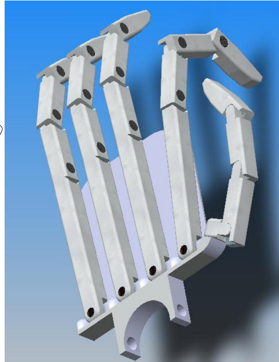
Abbildung 81. Handkonstruktion mit Seilbeuger und speziellen Fingerspreizmechanismus (links); CAD-Modell von vereinfachter Handkonstruktion(rechts)
