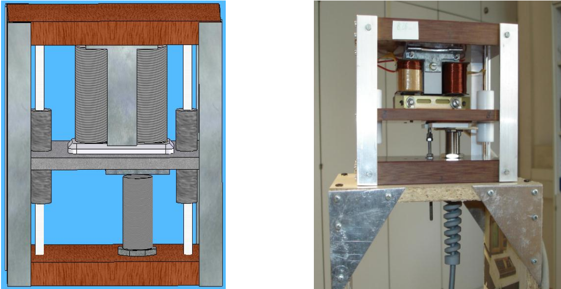
Abbildung 17. Der Versuchsaufbau des Magnetlagers mit dem homogenen Magnetfeld
