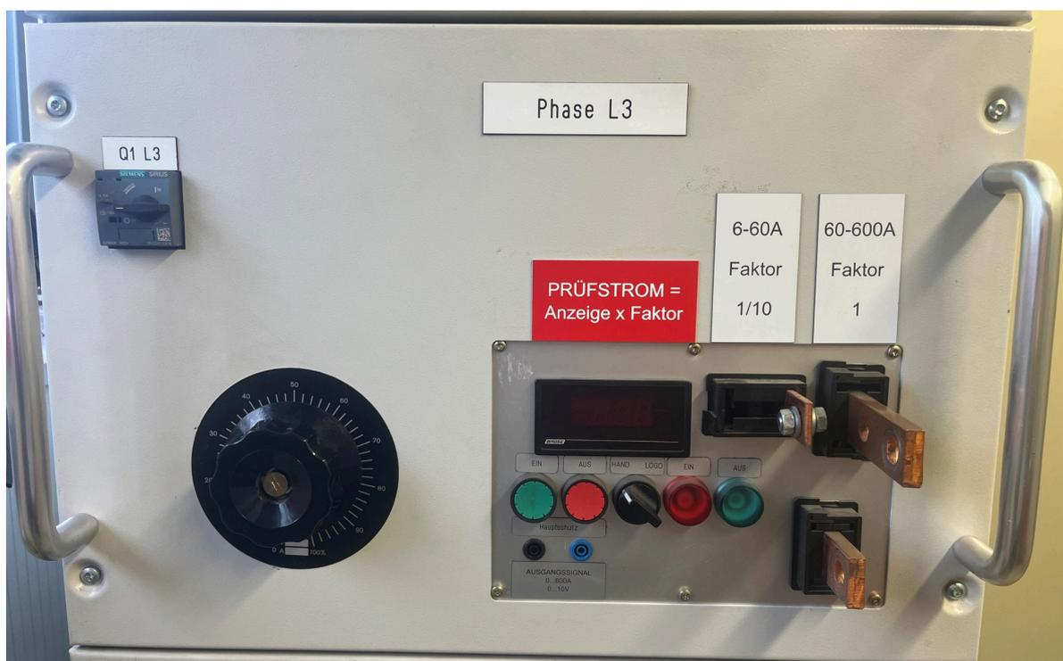
**Abbildung 5:** Bedienung einer Phase der mobilen EVA VII
