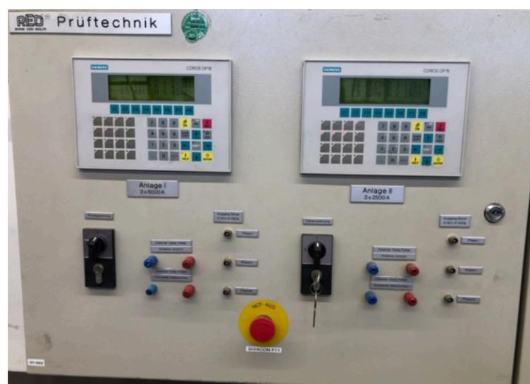
Abbildung 7: Bedienungskonsolen von zwei stationären EVAs
