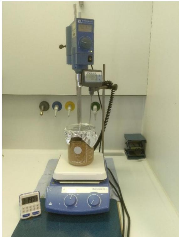
Abbildung 17: Versuchsaufbau für die alkalischen und sauren Aufschlüsse
