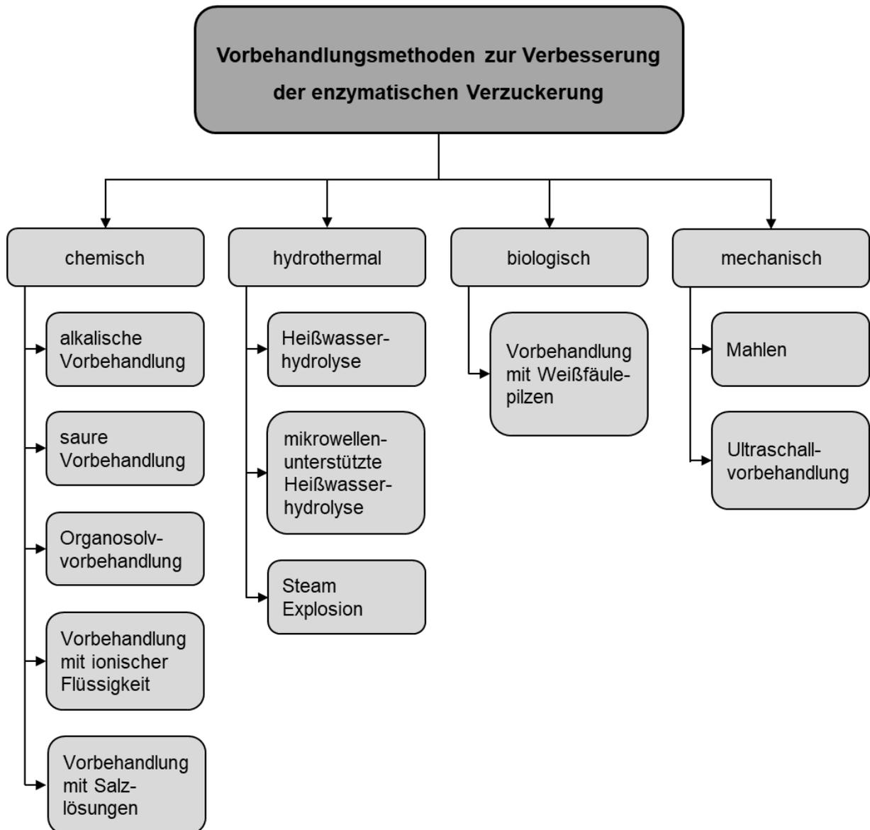
Abbildung 9: Überblick über mögliche Vorbereitungsverfahren für eine enzymatische Verzuckerung zur Produktion von Ethanol aus lignocellulosehaltiger Biomasse (eigene Darstellung auf Basis von [31 bis 33])
