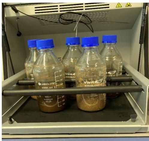
Abbildung 20: Fest eingespannte Proben im Inkubationsschüttler nach der Verzuckerung
