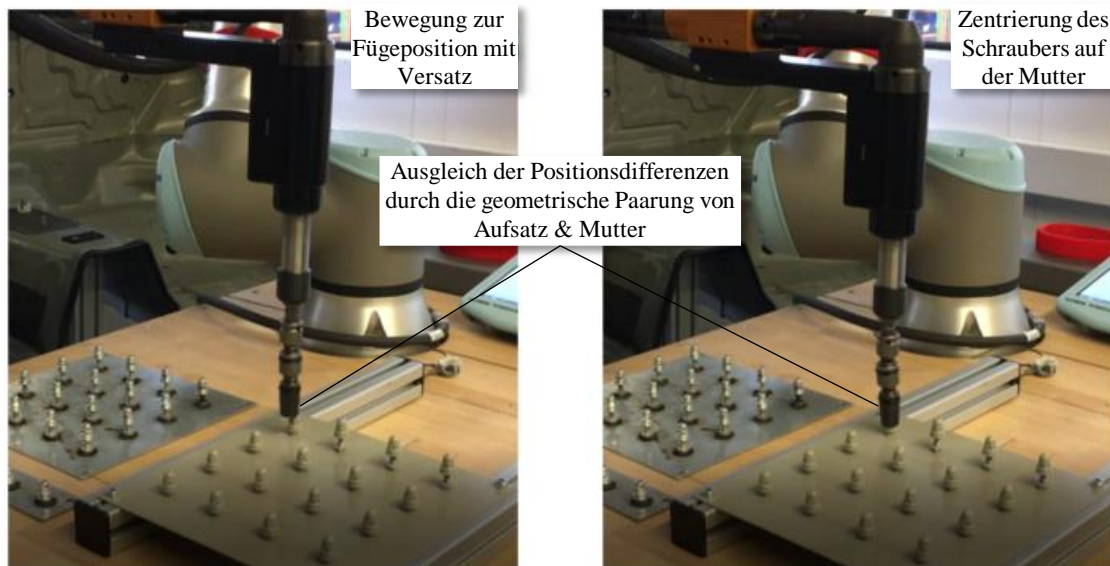
Abbildung 63: Untersuchung des Toleranzausgleichs eines Schraubers für das Lösen von Massemuttern
