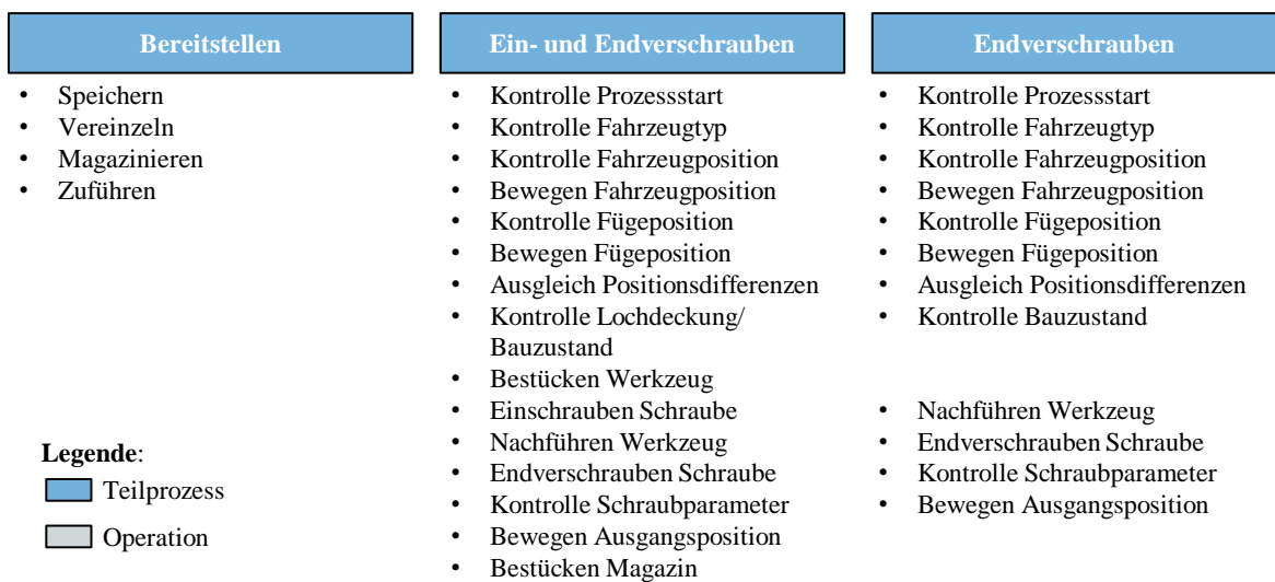
Abbildung 39: Teilprozesse und Operationen zum Verschrauben von Verbindungselementen
