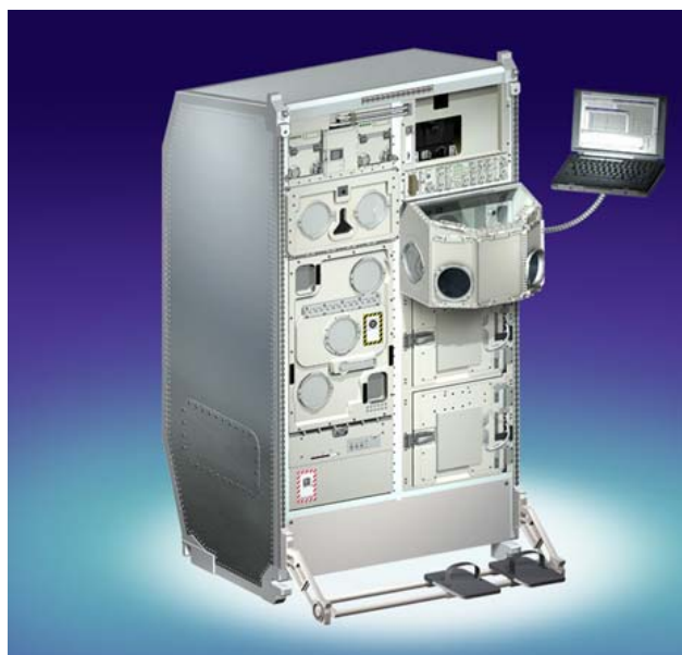
Abb. 12: Das Biolab Modul. Die TRIPLE LUX Experimente werden in speziellen Containern durchgeführt, wo die Daten während Zentrifugation (Referenz) oder unter Schwerelosigkeit erhoben und an die Erde geschickt werden. (ESA: http://newsimg.bbc.co.uk/media/images/44392000/jpg/_44392205_biolab_esa_203.jpg )
