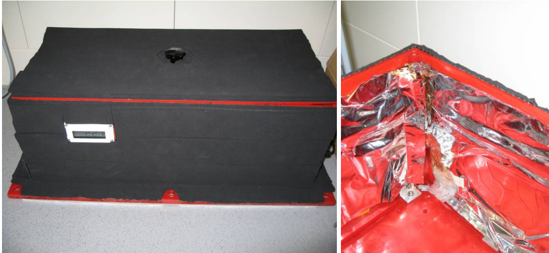
Abb. 33: Heizbox mit Moss Gummi (links) und Rettungsfolie (rechts) zur Isolation
